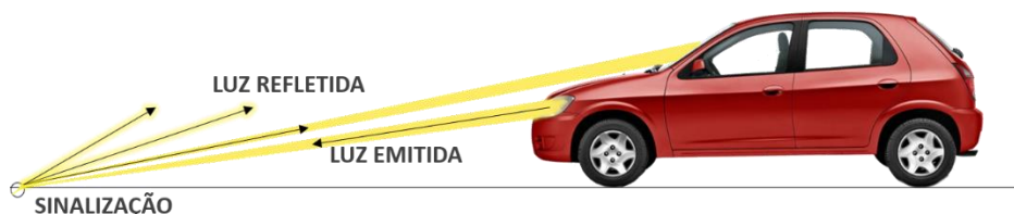
Figura 4 - Fenômeno de Retrorrefletividade em sinalizações horizontais
