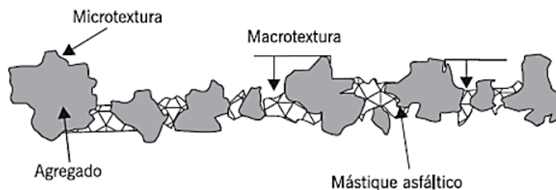
Figura 15 - Representação da microtextura e macrotextura superficial de pavimentos vista em corte
