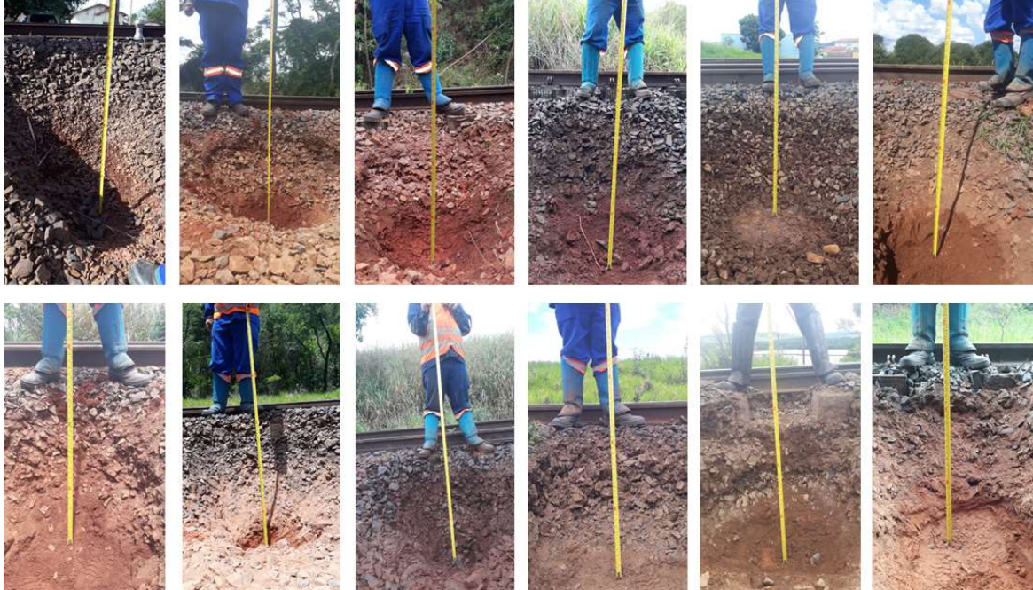
Figura 34 - Altura do lastro e segmentação
