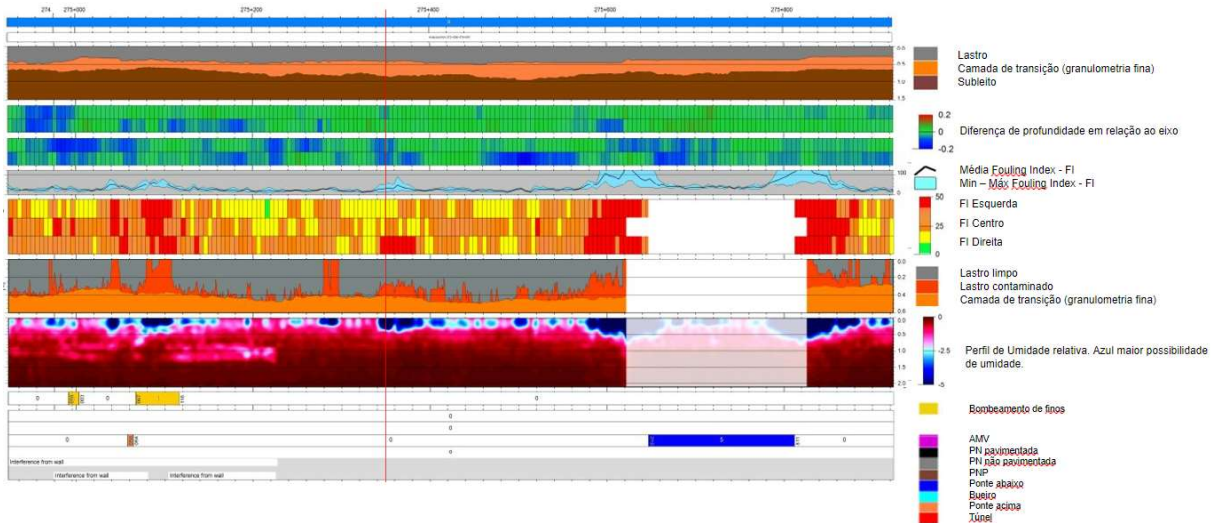
Figura 31 – Exemplo de saída a partir da investigação com GPR
