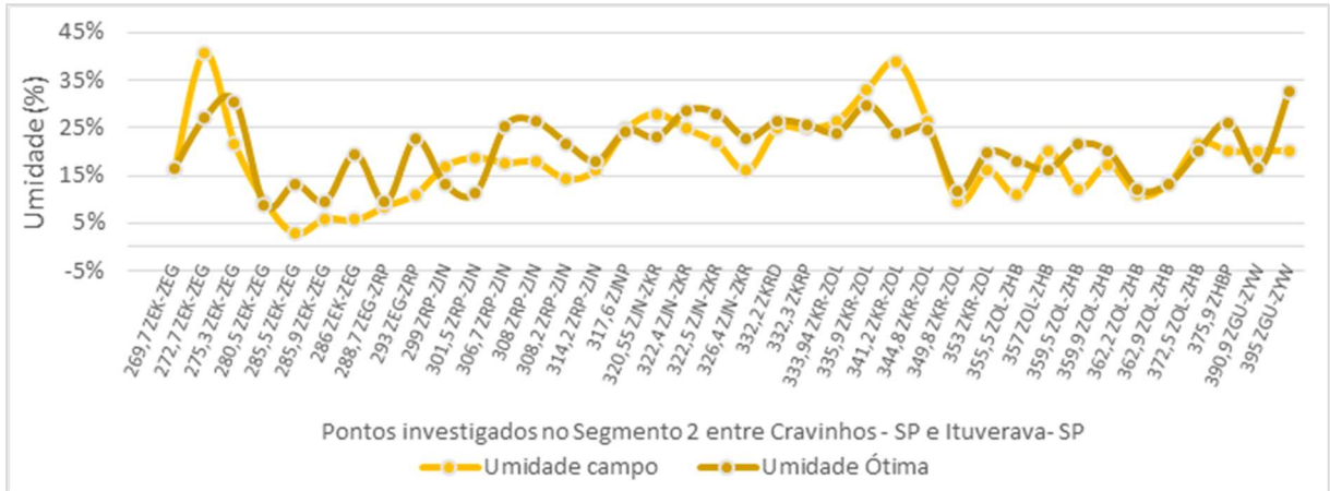
Gráfico 33 - Umidade de campo x umidade ótima no segmento 2
