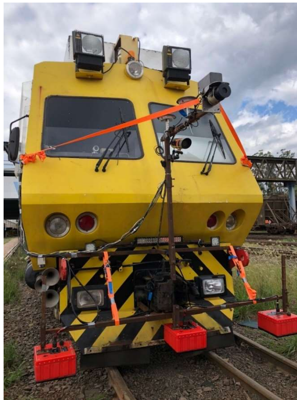
Figura 30 - Configuração do sistema de medição de plataforma ferroviária
