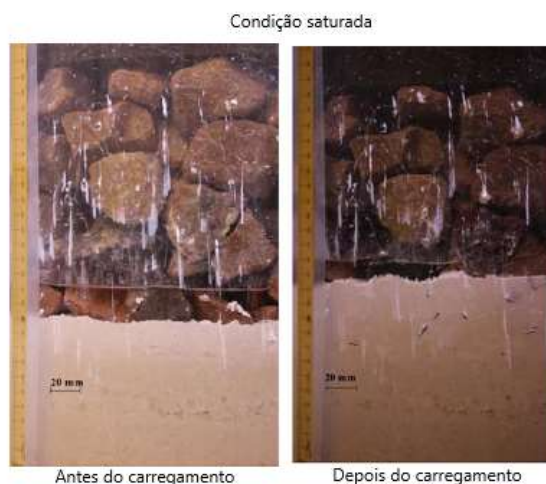
Figura 13 - Influência da umidade na interpenetração do lastro e no bombeamento de finos para a massa específica seca de 1,6 mg/m 3
