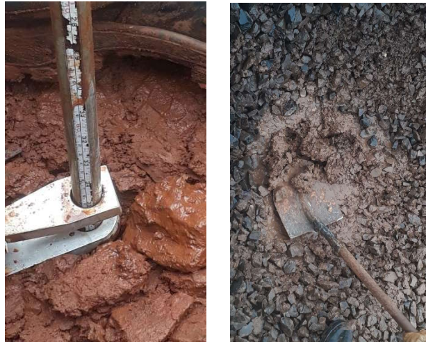
Figura 38 - Subleito saturado kms 264+300 ZCE-ZEK (esquerda) e 193+600 ZTDD (direita)
