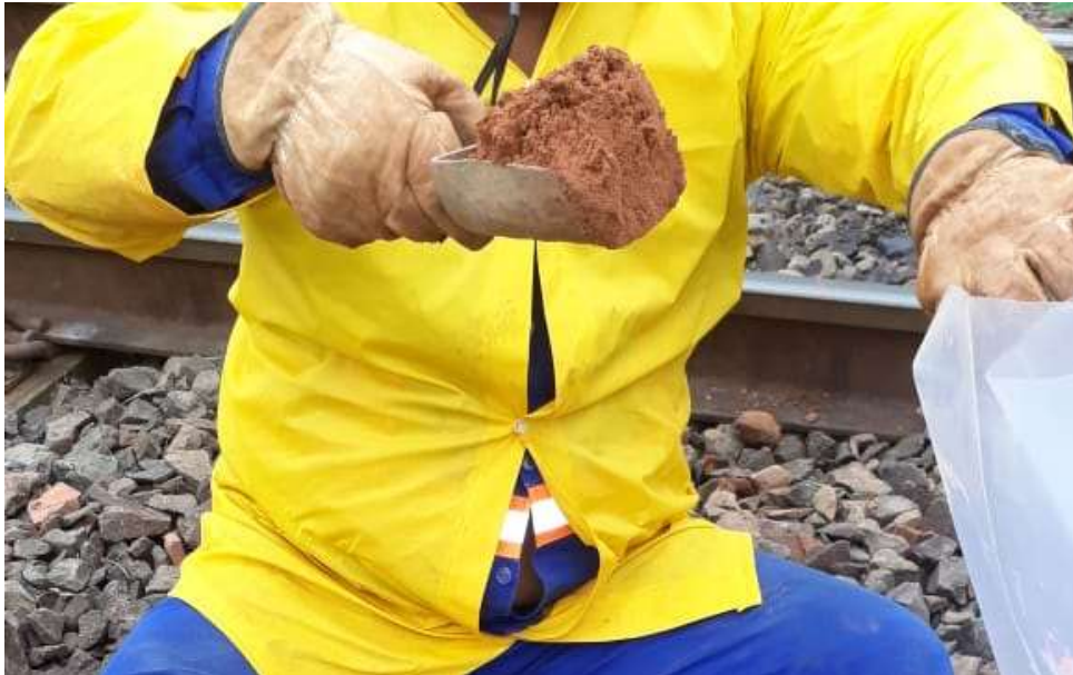
Figura 37 - Amostra de subleito coletada no km 195+100 ZTD3
