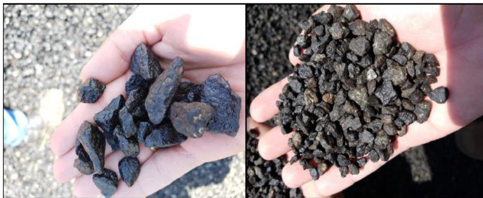
Figura 37 - Pré envolvimento realizado nos agregados (brita 1 e pedrisco, respectivamente).
