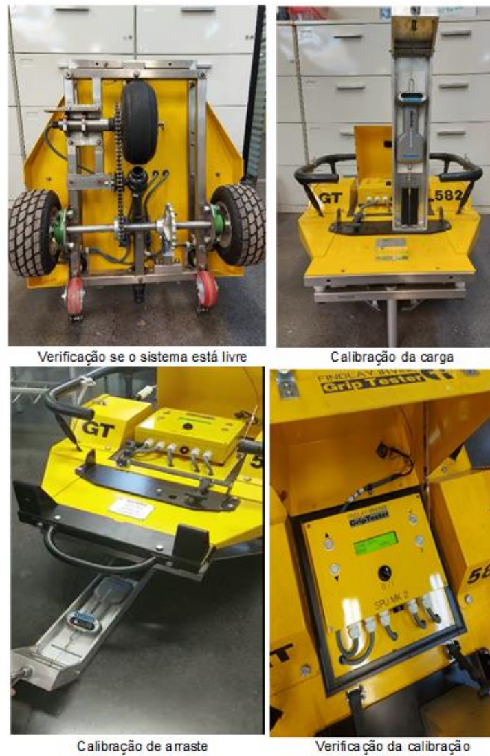
Figura 26 - Processo de calibração do grip-tester
