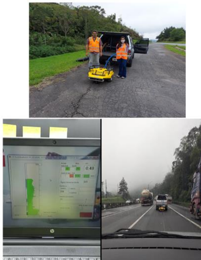
Figura 28 – Montagem do equipamento grip-tester e monitoramento dos trechos experimentais na Rodovia Régis Bittencourt
