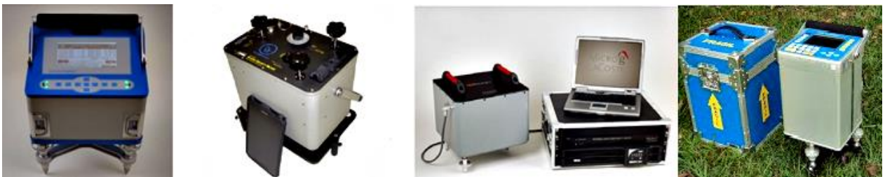
Figura 9 - Gravímetros relativos (esquerda para direita): Scintrex CG6 (Micro-g LaCoste), Burris (ZLS), gPhone (Micro-g LaCoste) e Scintrex CG5 (Micro-g LaCoste) .
