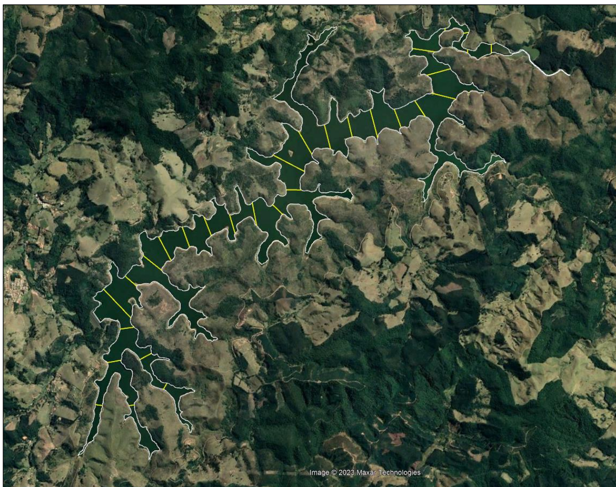
Figura 41 - Linhas de batimetria convencional planejadas para serem realizadas no corpo d'água do reservatório de Cachoeira. As linhas amarelas correspondem as seções batimétricas planejadas e o polígono branco o limite do corpo d'água do reservatório
