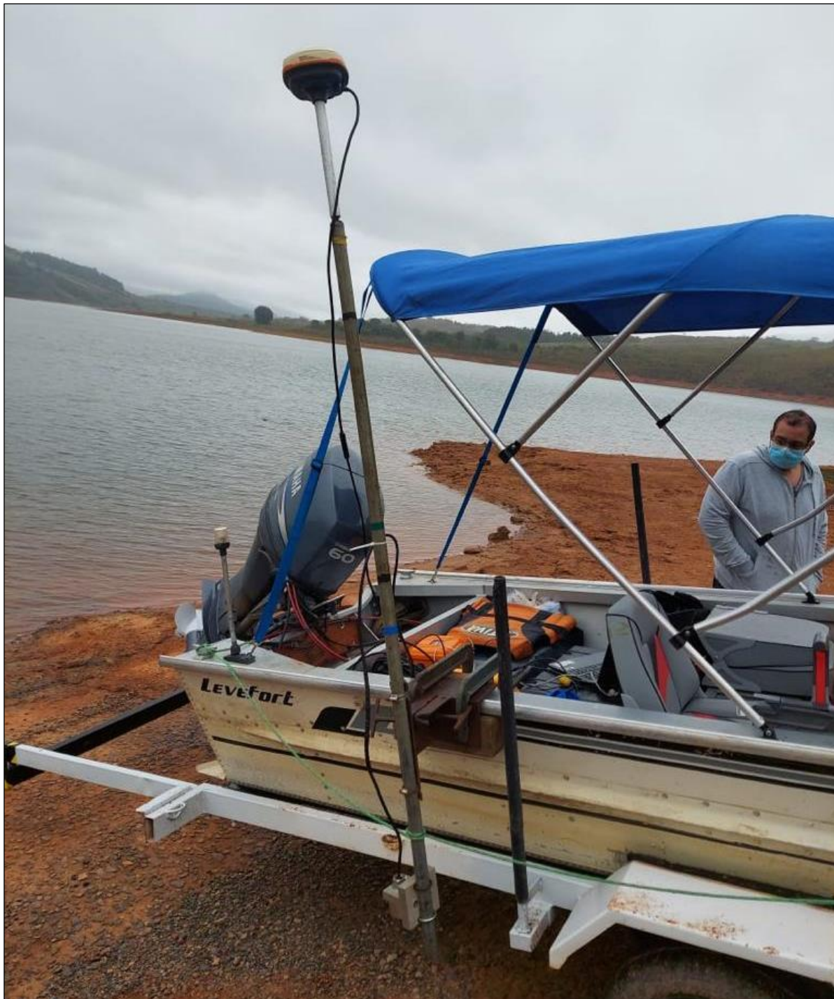
Figura 43 - Montagem do bastão contendo a antena GNSS na parte superior acoplado na embarcação
