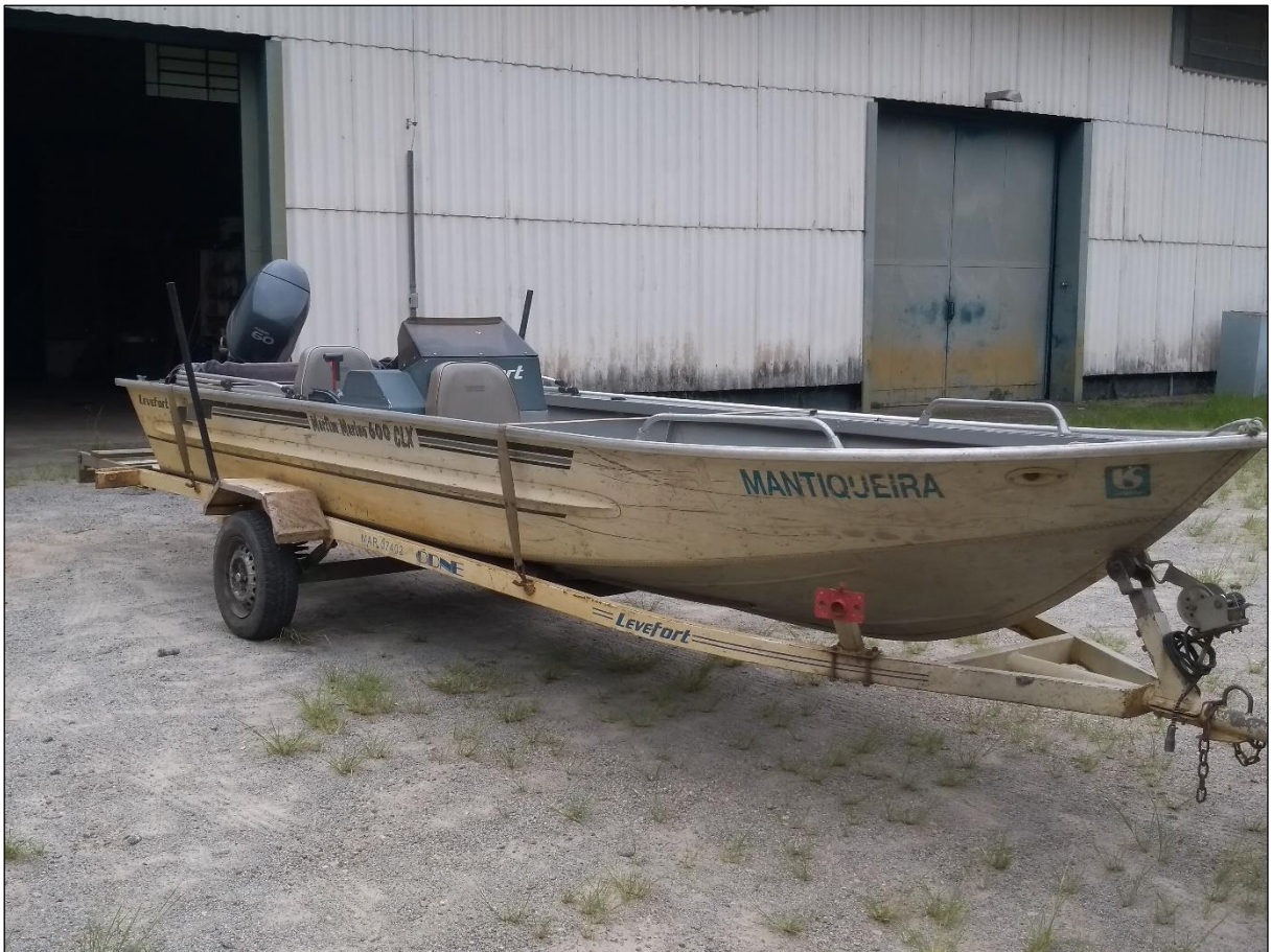
Figura 42 - Barco de alumínio do tipo voadeira, de propriedade da SABESP, utilizado na coleta de dados utilizando single-beam
