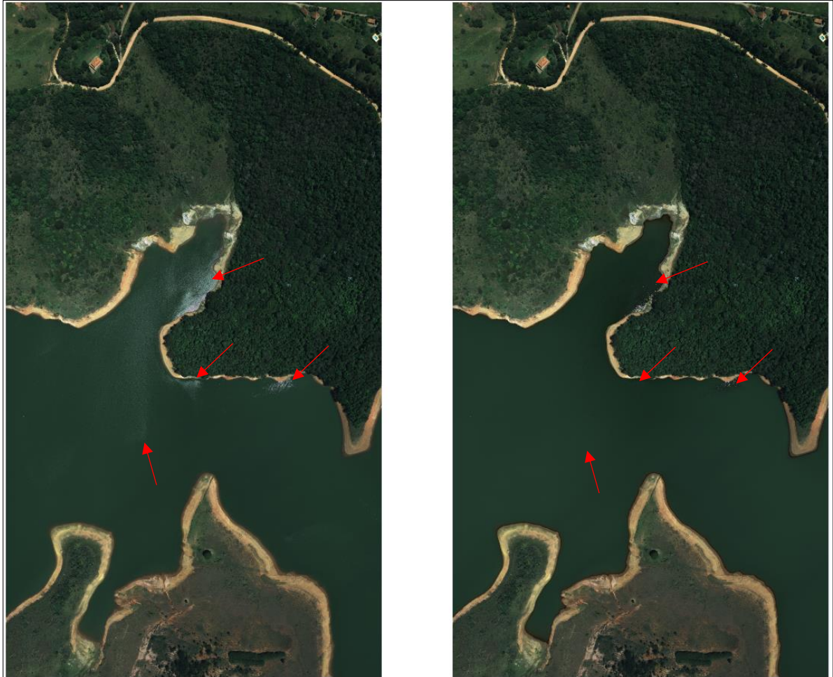
Figura 32 - Imagens multiespectrais tomadas para o reservatório de Cachoeira onde em A tem-se a imagem original contendo o sun-glint e em B a imagem corrigida. Nas duas figuras as setas vermelhas indicam as regiões afetadas pelo sun-glint (A) e corrigida (B).
