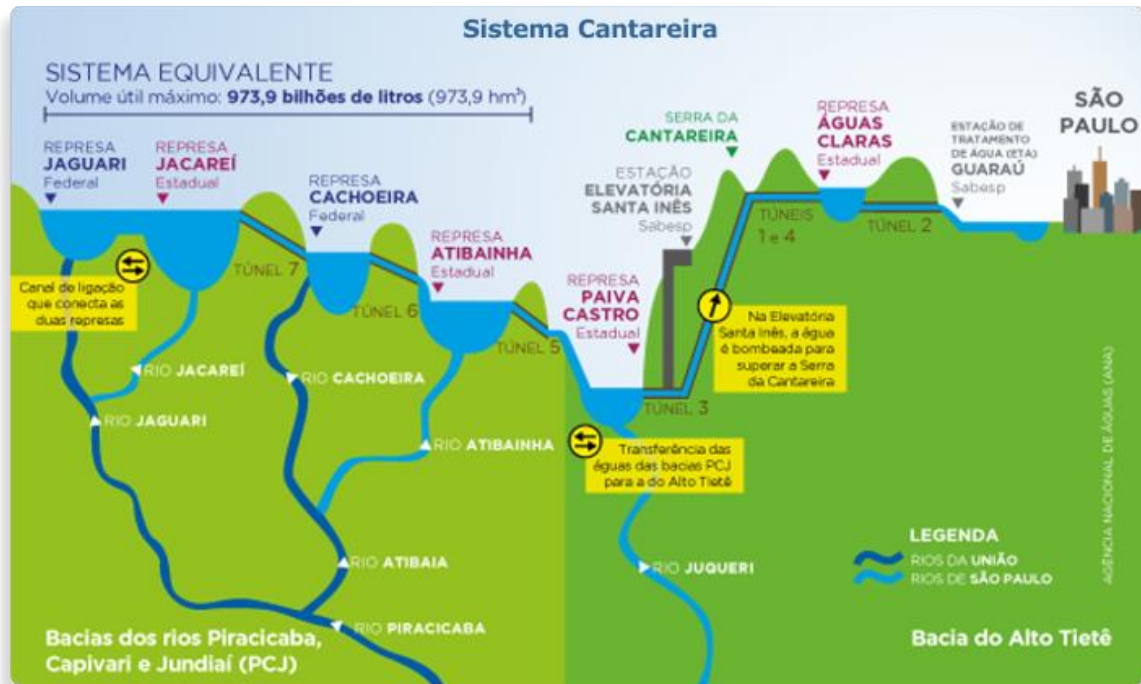
Figura 21 - Esquema da localização, disposição e interligação das represas integrantes do Sistema Cantareira
