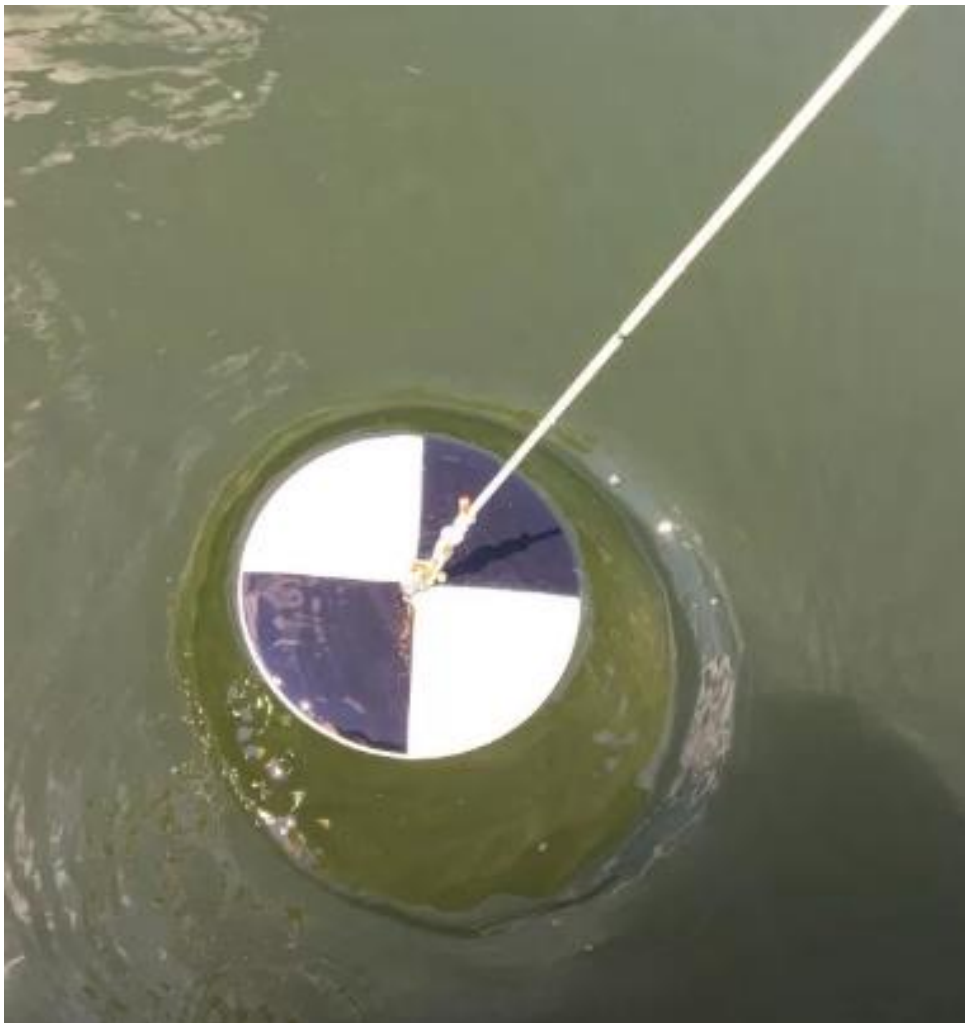
Figura 8 - Utilização do disco secchi na avaliação da turbidez da água
