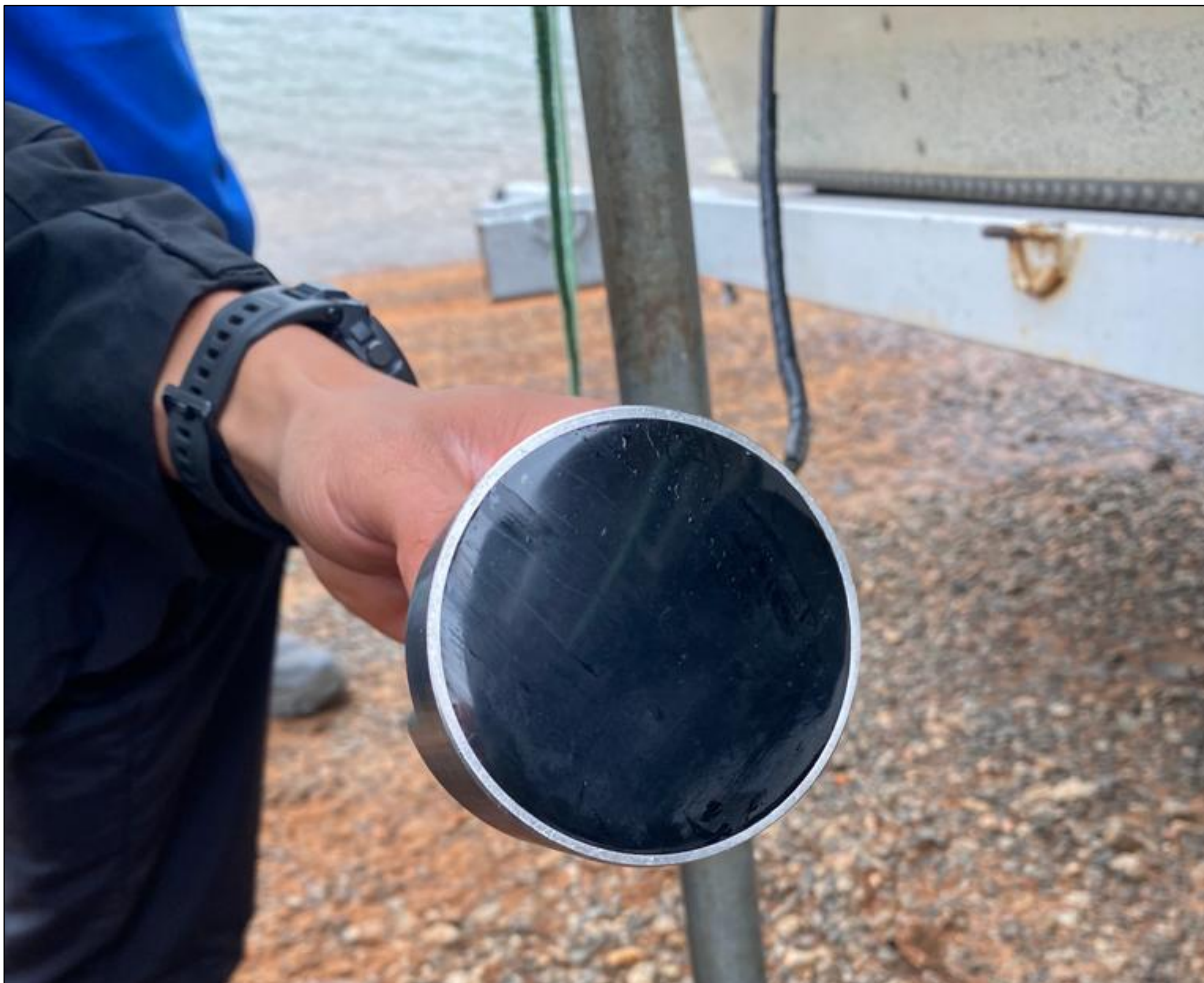
Figura 44 - Single-beam modelo Bathy-500MF ( Ocean Data ) utilizado na coleta dos dados
