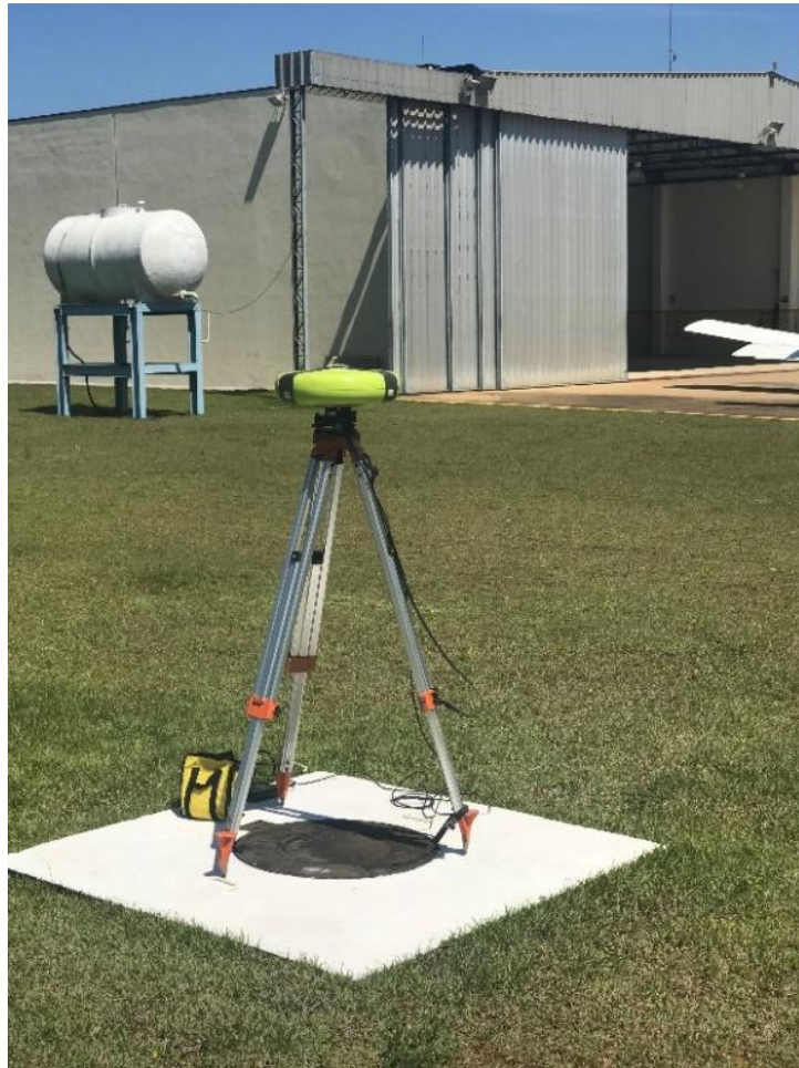
Figura 23 - Receptor GNSS instalado nas proximidades do hangar da empresa Fototerra em Bragança Paulista como base de apoio ao voo fotogramétrico
