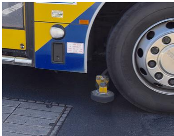
Figura A-8: Direção guiada por roda lateral em ônibus na Austrália
