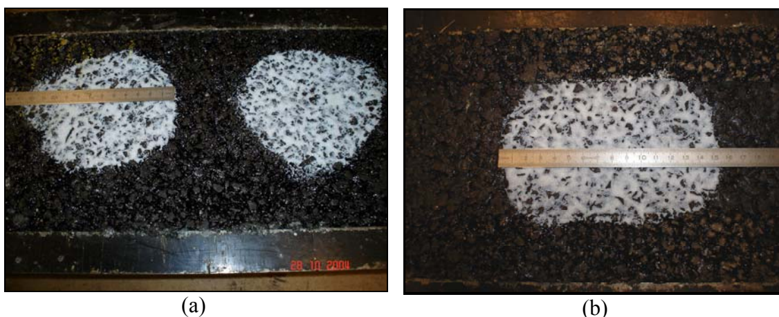
Figura 3.7 – Mancha de areia do BBTM 0/6 (LCPC) no ciclo 0 (a) e após 3.000 ciclos (b)
