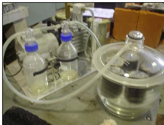
Figura 3.20 – Aplicação da pressão de 47kPa nos copos-de-prova destinados à imersão em água
