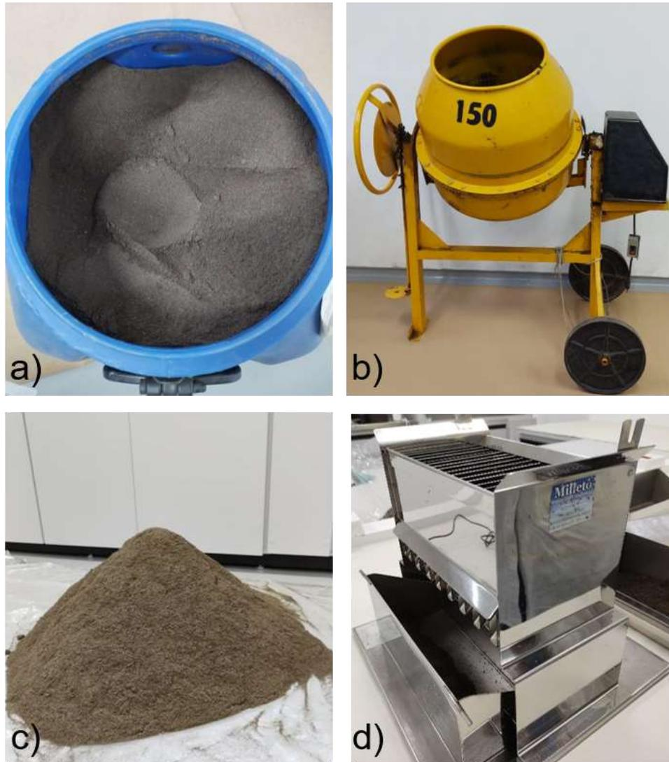
Figura 7. Bombona contendo a escória (a), betoneira (b), pilha cônica (c) e quarteador Jones (d) utilizados durante a homogeneização das amostras.
