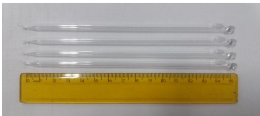
Figura 25. Amostradores a vácuo utilizados para retirada de amostras de ferro-gusa.
