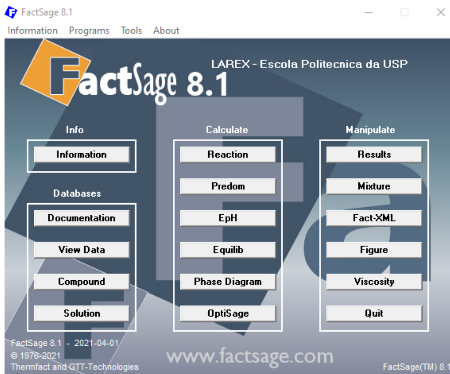
Figura 29. Tela inicial do software FactSage mostrando as opções de módulos de cálculos disponíveis.
