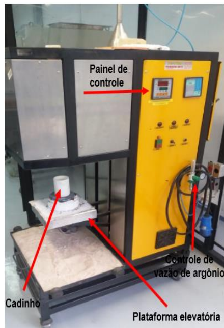
Figura 23. Forno de resistência elétrica de MoSi 2 modelo FE50RP utilizado nos experimentos de dessulfuração de ferro-gusa.
