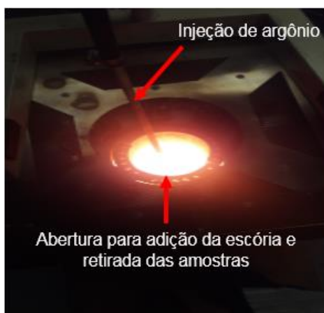
Figura 24. Abertura na parte superior do forno utilizado para adição das escórias dessulfurantes e a retirada das amostras.
