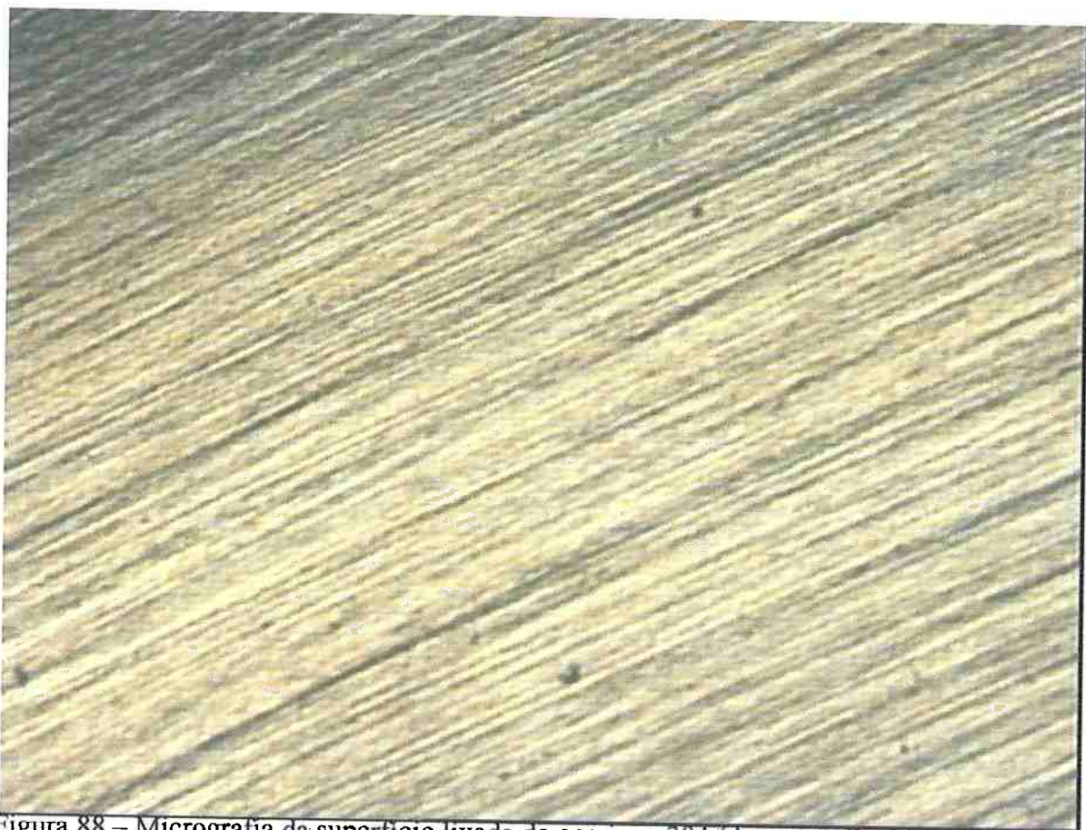
Figura 88 – Micrografia da superfície lixada do aço inox 304 (Aumento final 36x), antes de qualquer ensaio realizado
