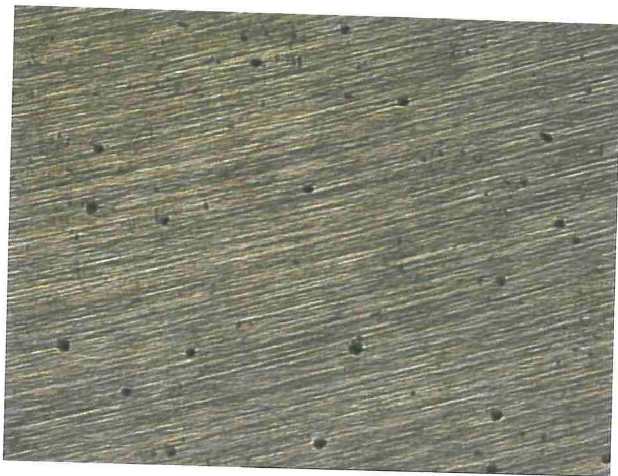
Figura 90 – Micrografia da superfície do aço inox 304 em água pura + 200ppm de cloreto - ensaio estático, a 90°C, após o levantamento da curva de polarização potenciodinâmica. (Aumento final 36x).
