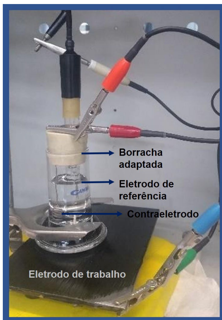
Figura 34 – Imagem fotográfica da célula eletroquímica de três eletrodos utilizada nas medidas de EIE, modelo PTC1 da Gamry
