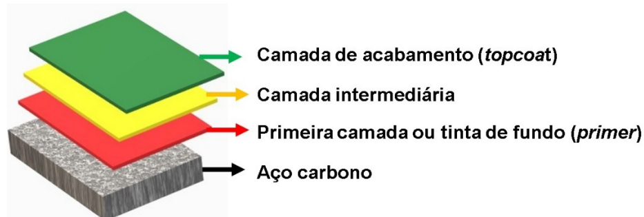
Figura 5 – Esquema de pintura de três camadas sobre um substrato metálico
