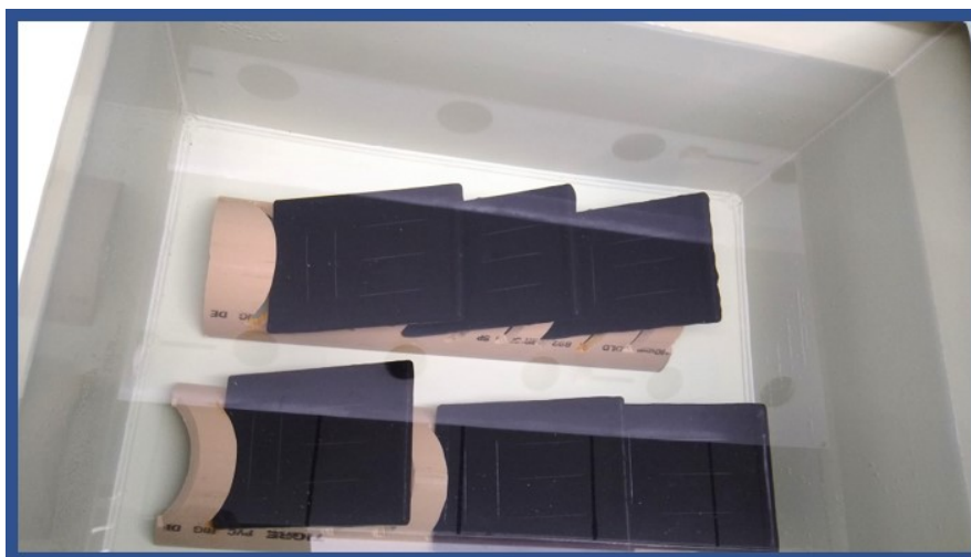
Figura 36 – Corpos de prova pintados submetidos ao ensaio de corrosão sob imersão em solução de NaCl 3,5 % em um tanque com capacidade de 80 L, à temperatura ambiente
