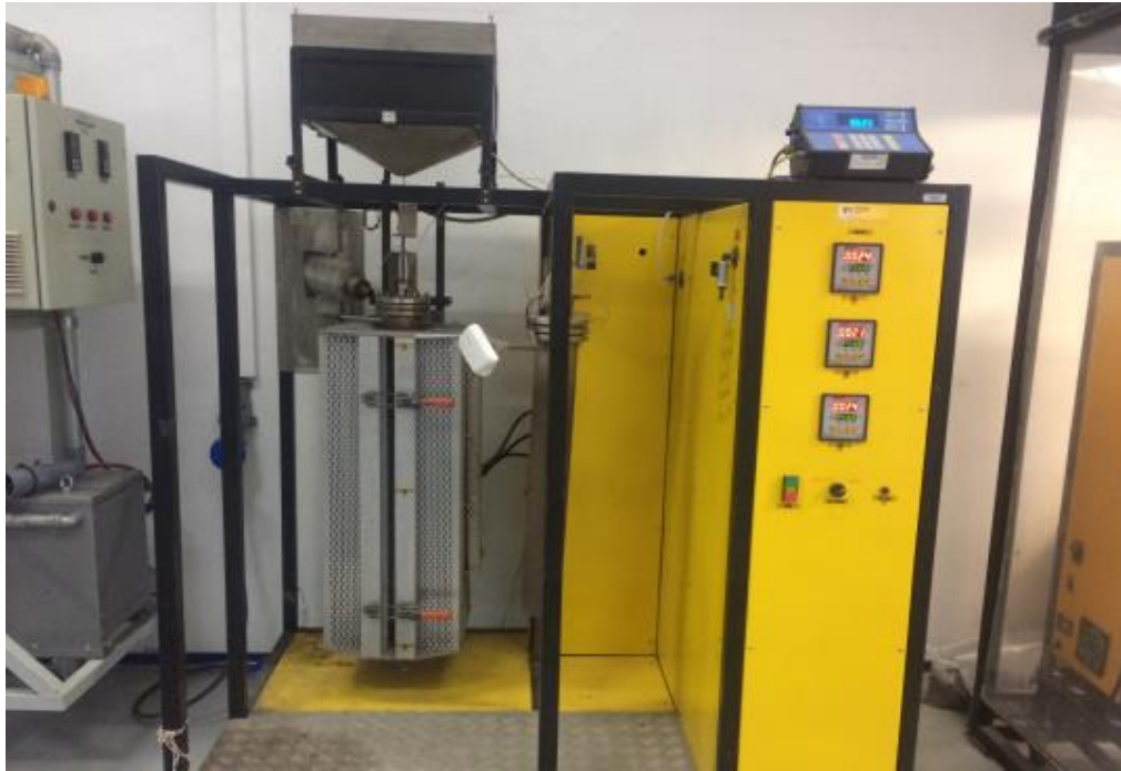
Figura 22. Forno utilizado para análise de redução
