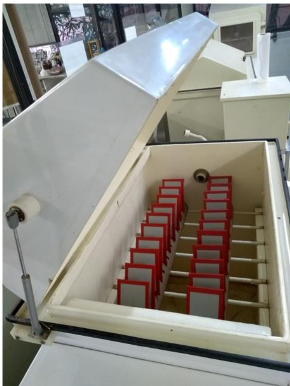
Figura 33 - Chapas de aço carbono revestidas com tinta epóxi utilizadas nos ensaios em câmara de névoa salina.
