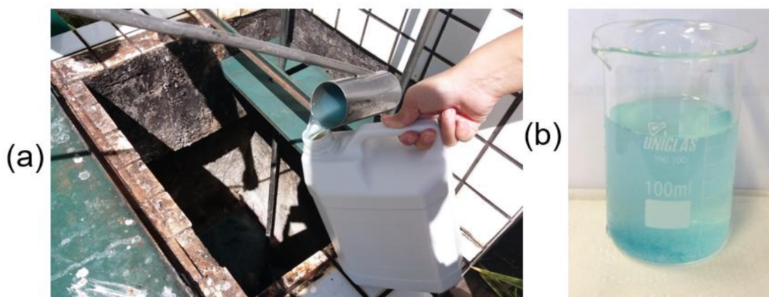
Figura 4.2 – Registro do momento da coleta do efluente residual do processo de produção de contraceptivos (ERC) (a) e amostra do ERC (b).
