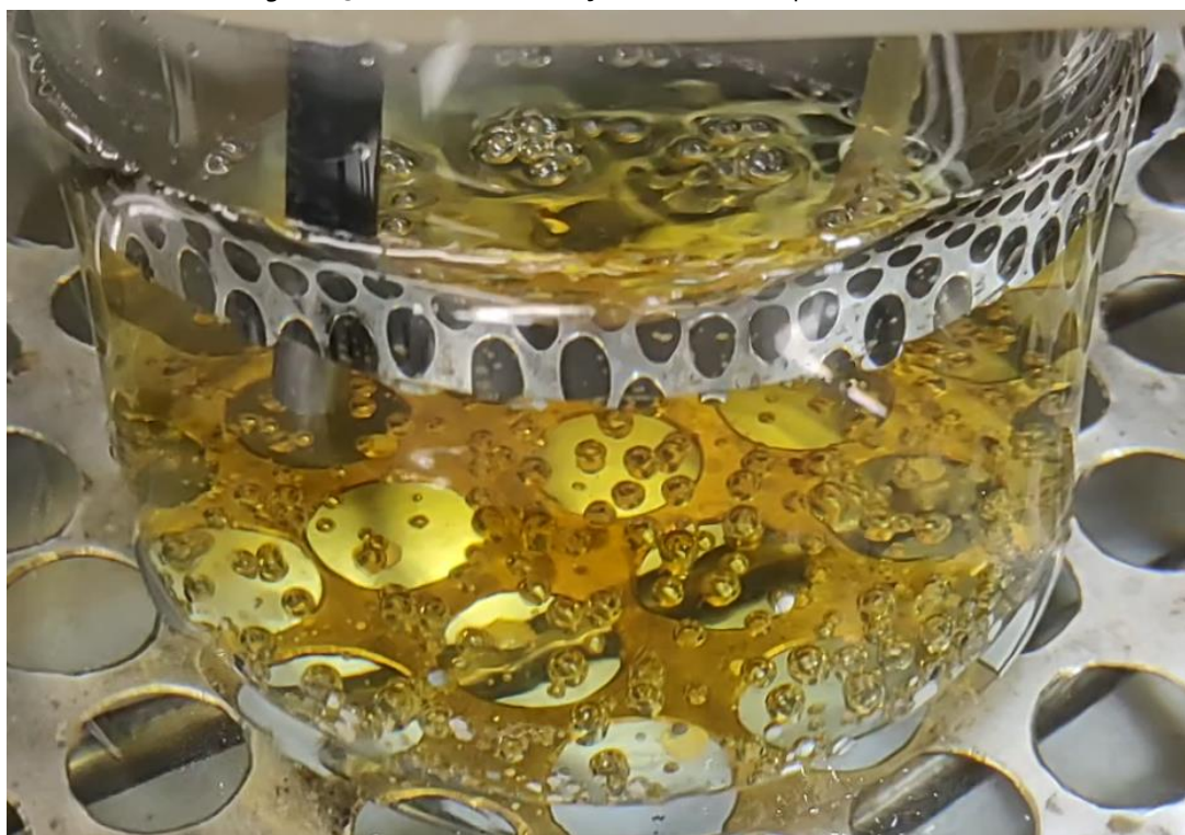
Figura B3 – Ensaio de dessorção intensificado por ultrassom
