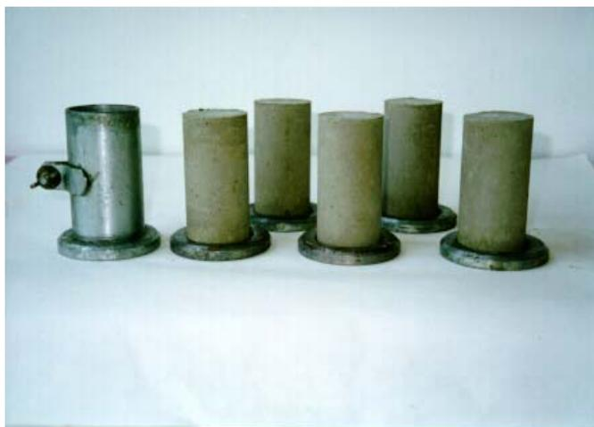
Anexo J – Corpos de prova para os ensaios de resistência à compressão e porosidade.
