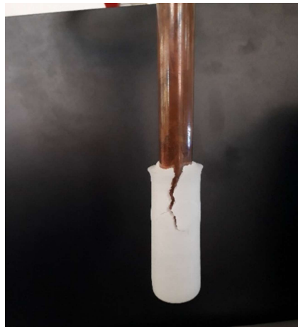
Figura 16 - Imagem da clivagem do ácido esteárico com a temperatura do fluido frio a 10°C. Fonte: O autor (2019).
