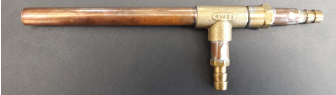
Figura 17 – Dedo frio utilizado no experimento. Fonte: O autor (2019).
