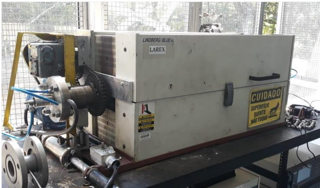
Figura 11 – Forno elétrico tubular utilizado nos ensaios do forno rotativo.
