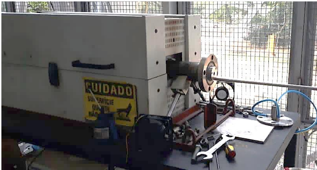
Figura 13 - Porta amostras sendo inserido no forno elétrico tubular
