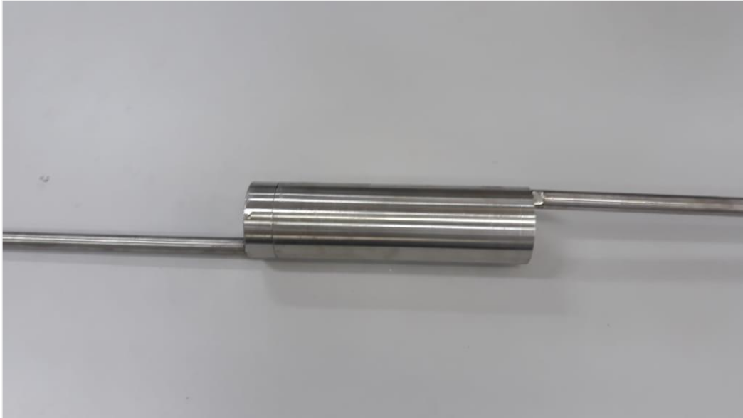
Figura 12 - Porta amostras de aço inoxidável com duas hastes.
