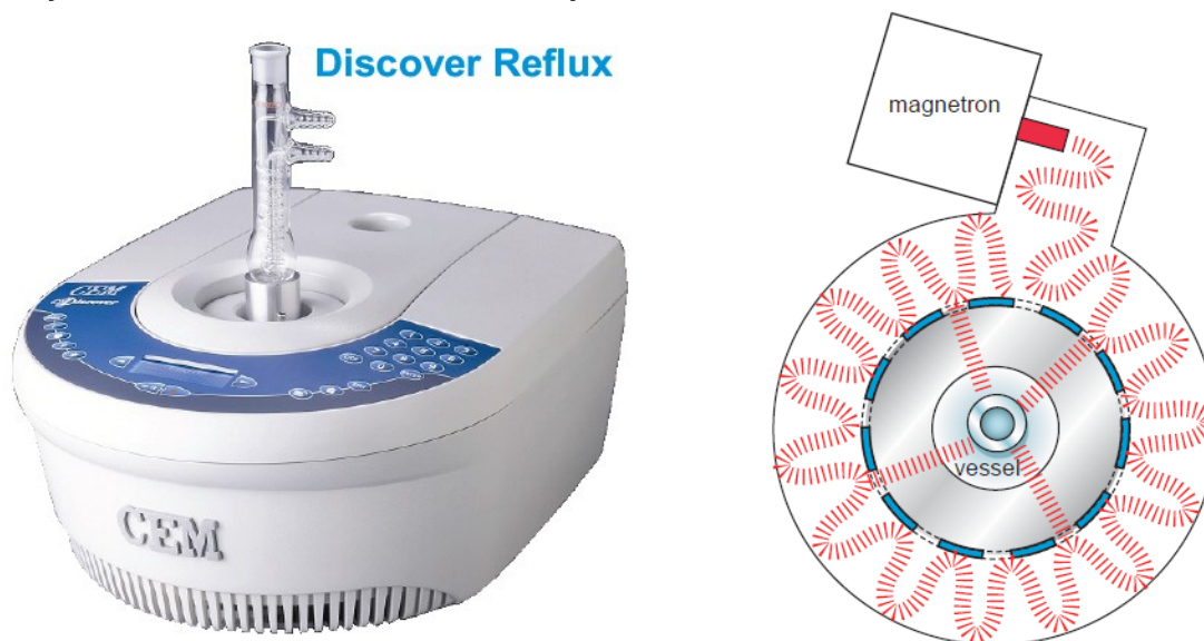
Figura 4.5: Ilustração e esquema do mini reator Discover Reflux da CEM Corporation, indicando a focalização de micro-ondas na cavidade de reação
