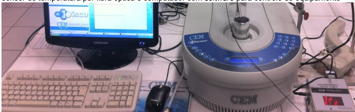
Figura 4.6: Mini reator Discover da CEM Corporation na bancada do laboratório, acompanhado de sensor de temperatura por fibra óptica e computador com software para controle do equipamento
