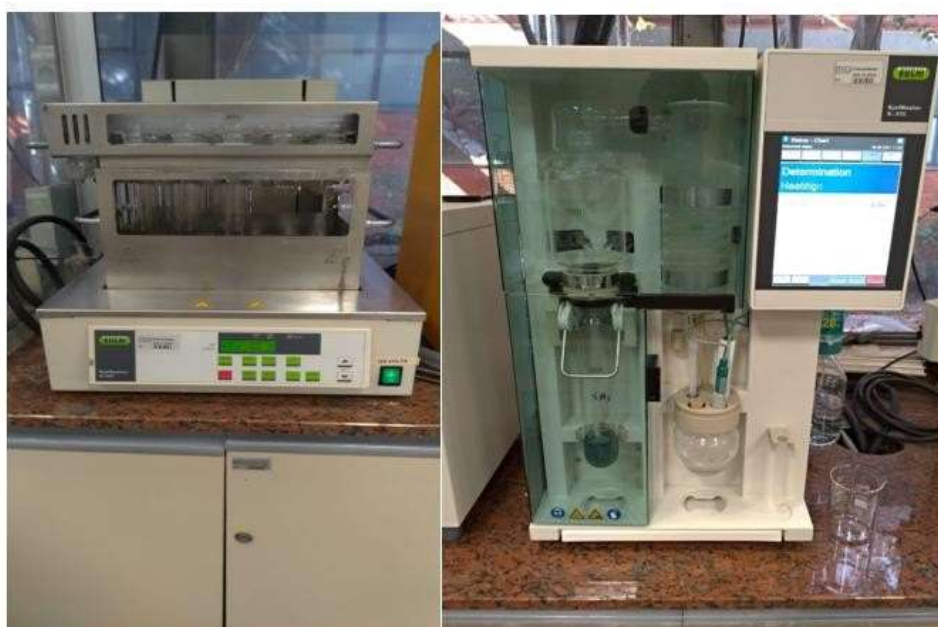
Figura 17 - Bloco digestor (esquerda) e destilador (direita) utilizados para determinação de proteínas [Autor (2022)]
