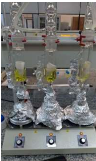
Figura 19 - Extração de lipídios utilizando o extrator soxhlet [Autor, 2022]
