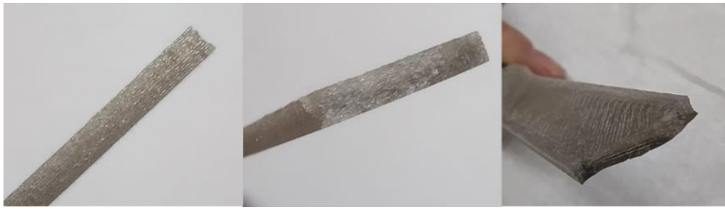
Figura 21. Visão lateral e frontal da fratura do corpo de prova após ensaio de tração
