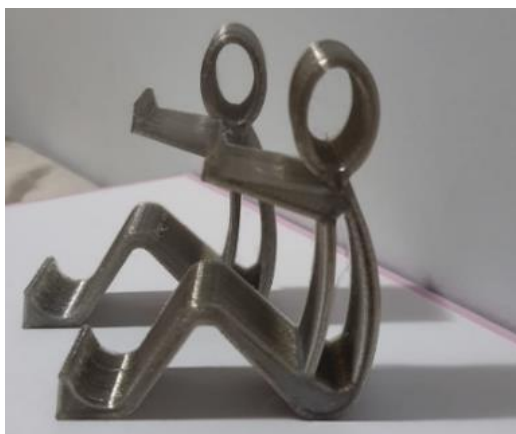
Figura 15. Suporte para celular produzido através da Manufatura Aditiva
