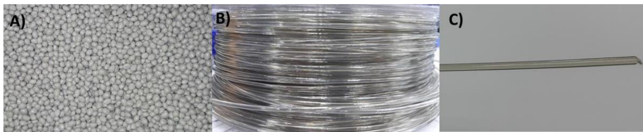
Figura 14. A) Resina PET PCR; B) Carretel de filamentos produzidos C) Filamento utilizado na impressora 3D
