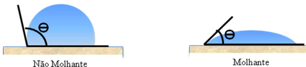
Figura 4.3. Ângulos de contato \theta : fluidos não molhante e molhante.
