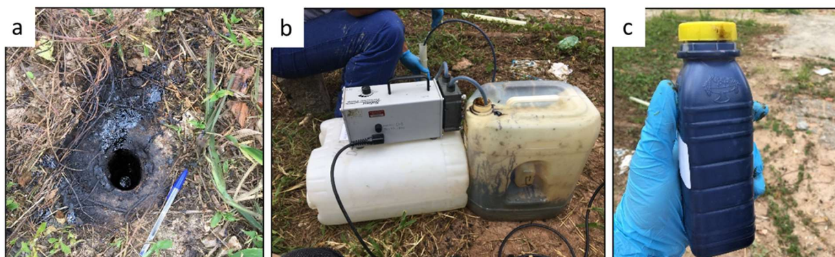
Figura 4.9. Fotos da coleta de amostras de solo. a) furo de sondagem; b) bombeamento do creosoto; c) creosoto em um dos recipientes.
