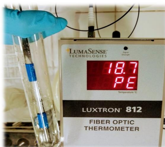
Figura 4.4 – Sistema de medição de temperatura: sensor de fibra óptica Fluoroptic STF-1M (LumaSense Technologies, EUA), dentro de um tubo de ensaio, conectado ao termômetro de fibra óptica Luxtron 812 (LumaSense Technologies, EUA).
