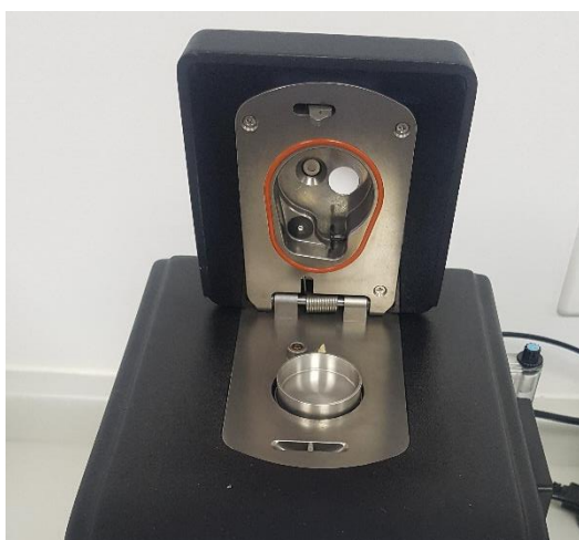
Figura 4.2 – Equipamento VSA (Vapor Sorption Analyser) utilizado para a produção de isotermas de sorção.
