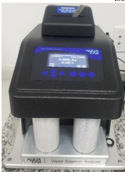
Figura 4.2 – Equipamento VSA (Vapor Sorption Analyser) utilizado para a produção de isotermas de sorção.
