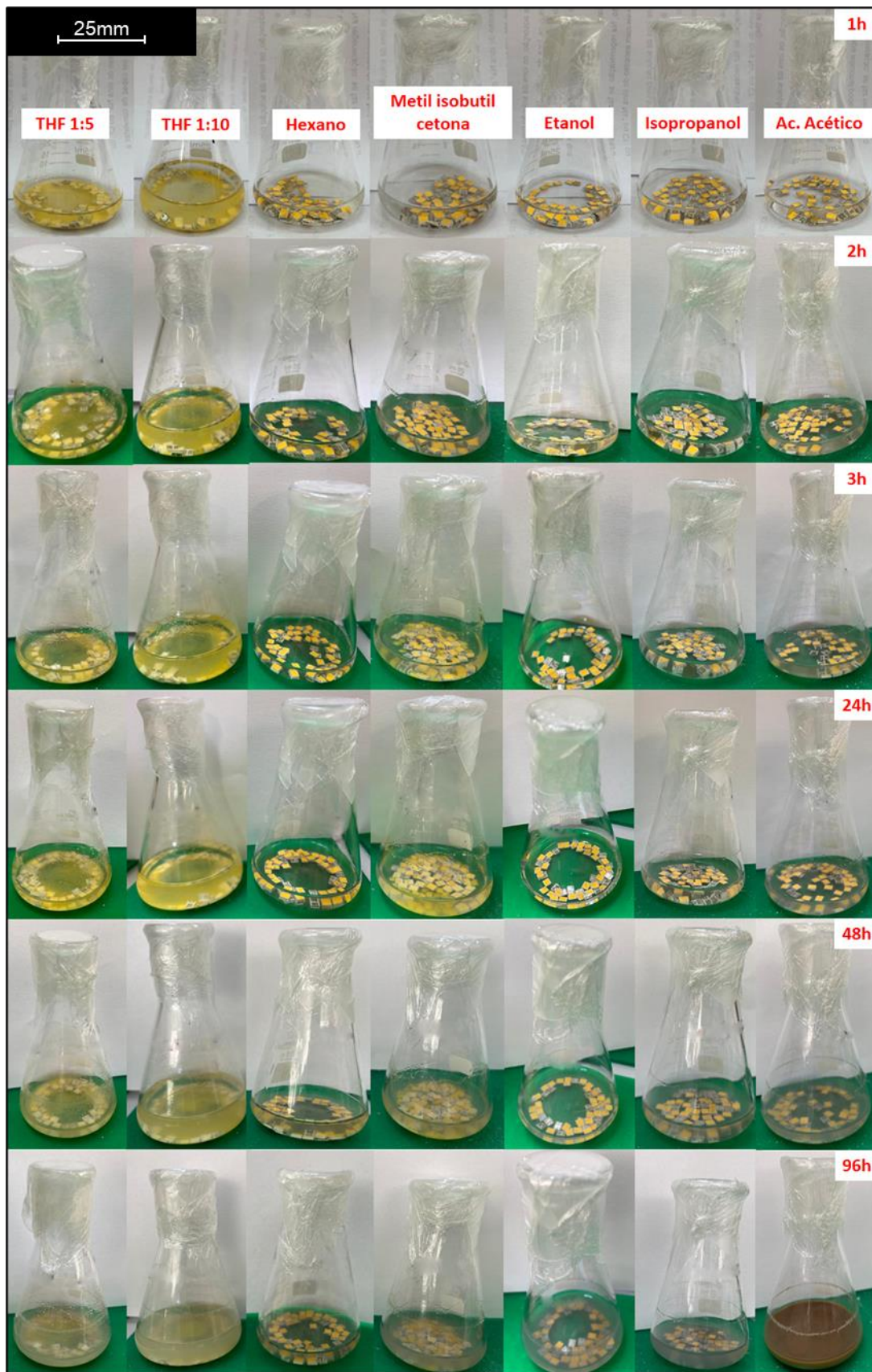
Figura 24. Ensaio de remoção e dissolução do encapsulante PDMS utilizando os solventes THF 1/5, THF 1/10, hexano, metil isobutil cetona, etanol, isopropanol e ácido acético nos tempos de 1, 2, 3, 24, 48 e 96h.
