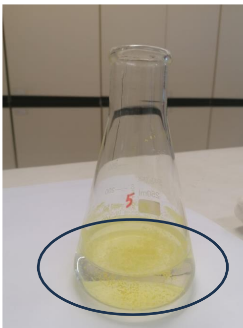
Figura 16. Formação de precipitado amarelo da interação do xantato com o cobre no ensaio (c).
