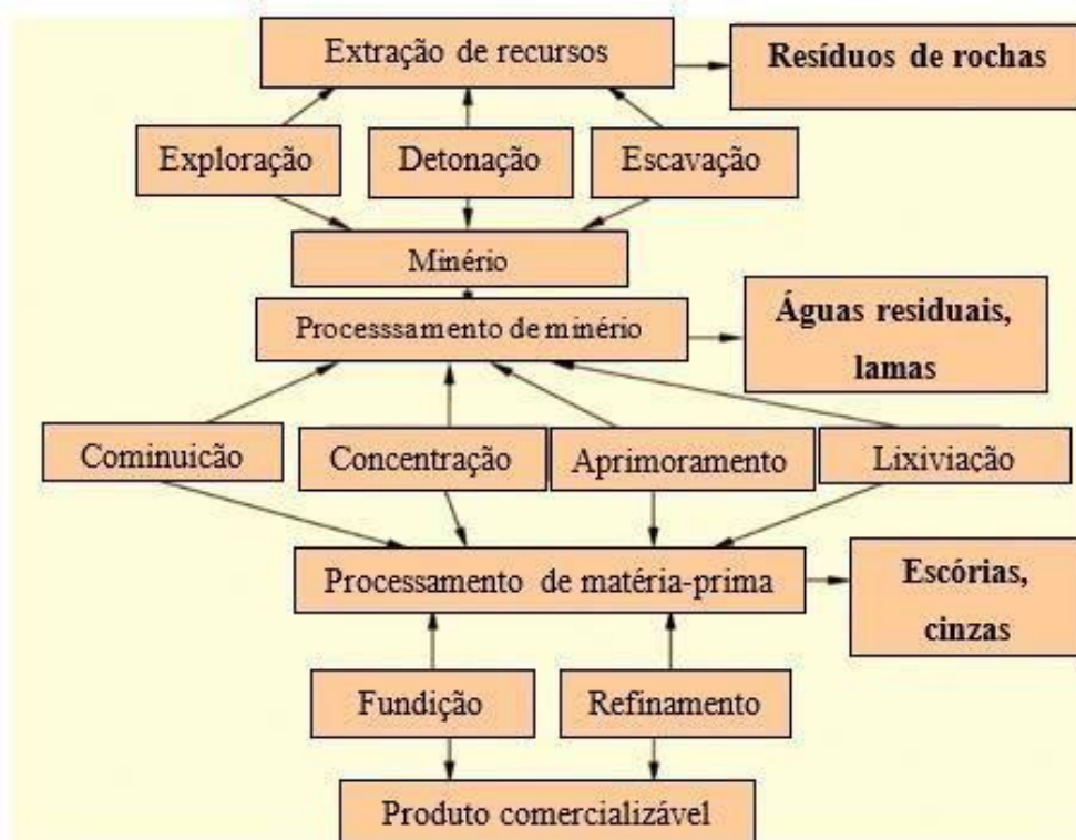
Figura 5. Processo de mineração e geração de resíduos. (Adaptado: Yellishetty et al., 2008; Kuranchie et al. 2014)
