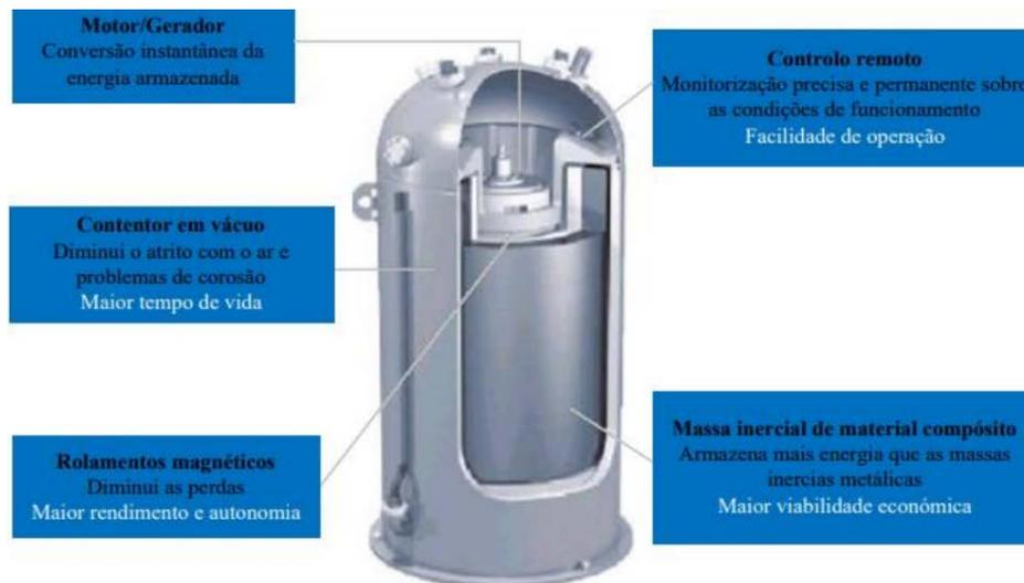
**Figura 20.** Esquema de um sistema de volante inercial. Fonte: Lopes, 2015
