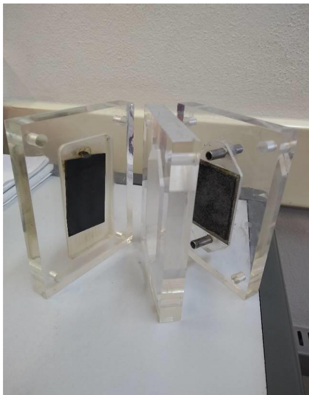
Figura 17 - Vista explodida da célula eletroquímica com os encaixes para os eletrodos.
