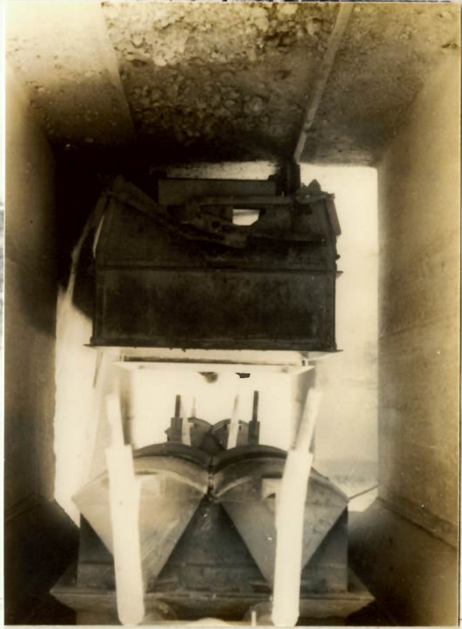
Foto 18 - Descarga de cal virgem dos fornos àzbe, das instalações da S.A. Industrias Votorantim, Município de Itapeva - SP.
