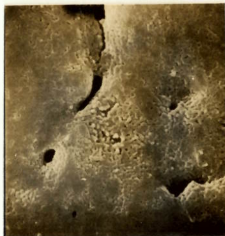
Fig. 2.11 - Textura observada em CaO obtido pelo aquecimento a 880°C, durante 60 minutos, à pressão de 6,65Pa. Aumento: 3500x (por cortesia de OBST, 1978).
