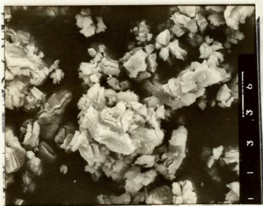
Amostra: Dc Forno: alvenaria descontínuo ABET: 0,86\text{m}^2/\text{g}
