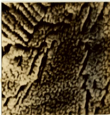
Fig. 2.10 - A mesma imagem da micrografia 2.9, sob aumento de 110.000\times . Observe-se início de desenvolvimento da textura (por cortesia de OBST, 1978).
