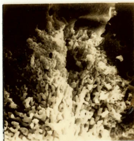
Fig. 2.6 - Micrografia obtida por MEV da interface CaCO 3 -CaO após um breve período de calcinação a 1000°C. Os cristalinóculos crescem da interface em sentido para fora da pedra, atingindo na amostra o tamanho de 7µm. Aumento: 500x (por cortesia de OBST, 1978).
