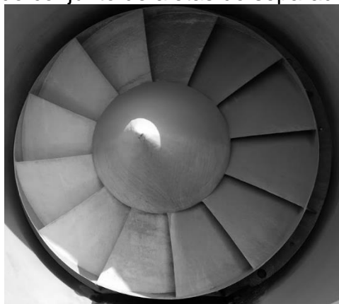
Figura 32: Vista superior do conjunto de aletas do separador cilônico de gotículas.
