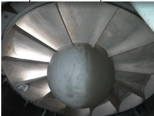
Figura 33: Vista inferior do conjunto de aletas do separador ciclônico de gotículas.
