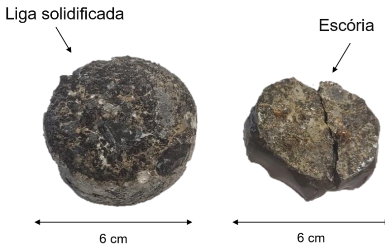
Figura 38 – Vista superior do bloco de resíduo solidificado e a respectiva camada de escória formada durante o ensaio E0,5C-10CAF2 do tratamento do resíduo de Fe-Si-Sn com silício.
