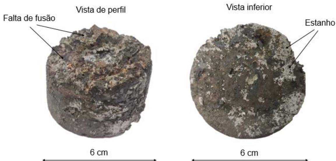
Figura 51 - Vista de perfil e inferior do bloco solidificado do ensaio Si80-6CaF 2 e identificação da falta de fusão total do resíduo e também algumas partículas de estanho metálico.
