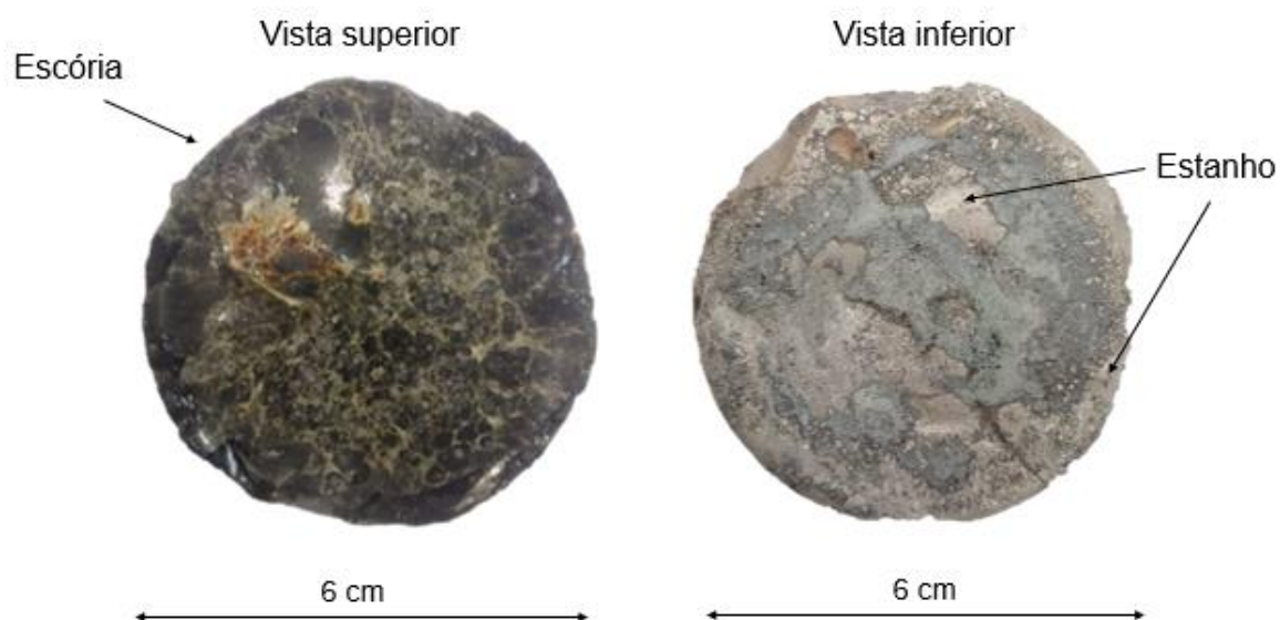
Figura 49 - Visão superior e inferior do bloco solidificado do ensaio \text{Si45-20Na}_2\text{CO}_3 . É possível identificar a fase de escória e estanho metálico.
