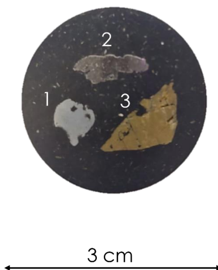
Figura 13 - Partículas do resíduo de Fe-Si-Sn embutidas para análise por Microscopia Eletrônica de Varredura.
