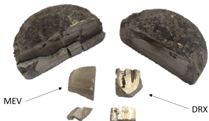
Figura 41 – Corte de regiões do bloco solidificado do ensaio E0,5C-10CAF2 para análises de MEV-EDS e DRX.
