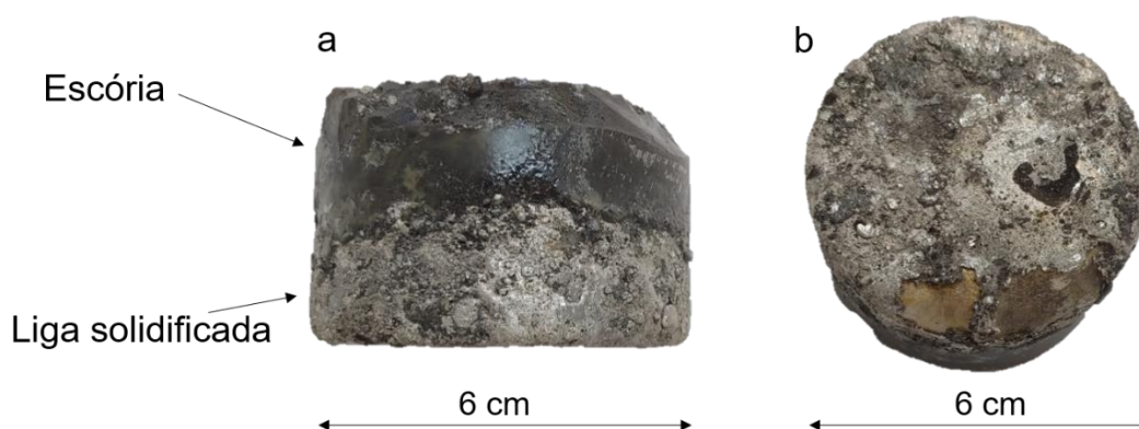
Figura 43 – a) Visão lateral do bloco solidificado do ensaio E0,5C-10NA2CO3 mostrando a fase de escória e a fase de ferro silício solidificada; b) Visão inferior do bloco solidificado do ensaio E0,5C-10NA2CO3.
