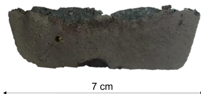
Figura 53 - Corte transversal do bloco solidificado do ensaio IPT-MIX.
