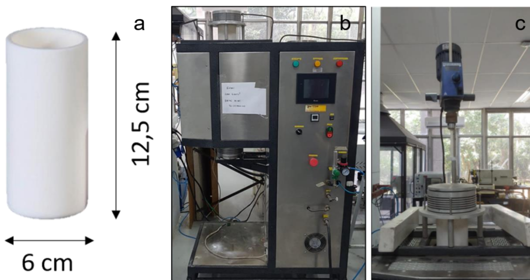
Figura 19 - a) Dimensões do cadinho de alumina; b) Forno de resistência utilizado para os ensaios de tratamento ferro silício do resíduo; c) Esquemática do modo de agitação do banho metálico.
