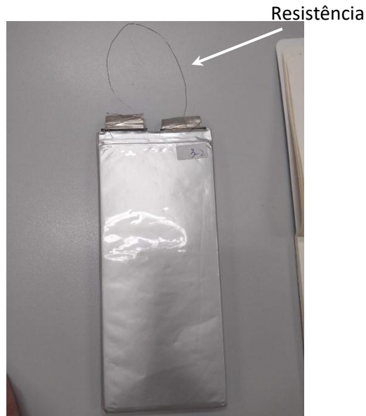
Figura 11 - Descarregamento da LIBs utilizando uma resistência de 4\Omega .
