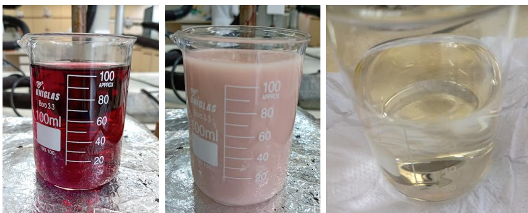
Figura 28 - Precipitação do oxalato de cobalto pela adição de ácido oxálico na solução com os componentes da bateria lixiviados em ácido cítrico.
