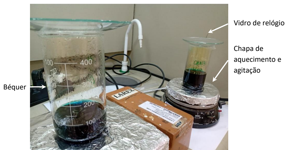
Figura 12 - Aparato experimental para digestão dos materiais ativos dos eletrodos das baterias com a utilização de água régia a 60^\circ\text{C} por 24h.
