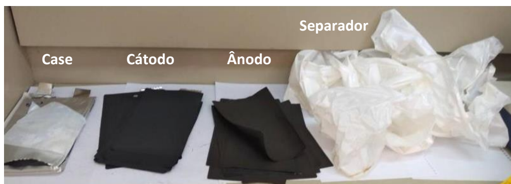
Figura 15 - Componentes das baterias de carros elétricos do tipo pouch , da direita para a esquerda: case, cátodo, ânodo e separador.
