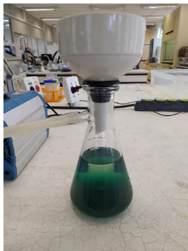
Figura 5-29: Licor de lavagem da escória calcinada com NaOH a 700°C por 3h. Após algumas horas em repouso, a coloração verde desaparece e ocorre a precipitação de um sólido marrom muito fino.
