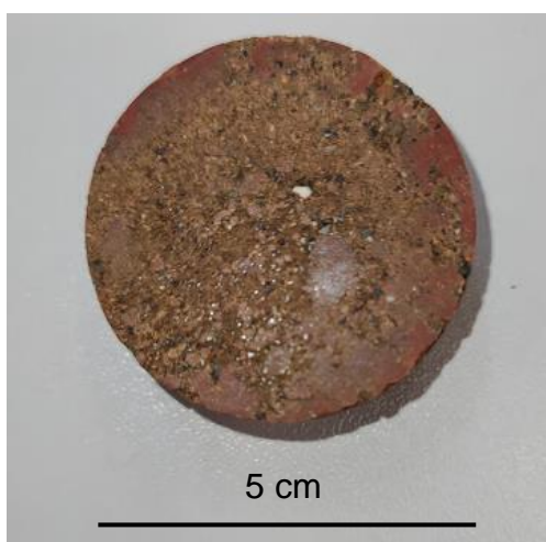
Figura 5-3: Pastilha de escória homogeneizada e quarteada, embutida em baquelite vermelho utilizada para obtenção de análise elementar via MEV acoplado com EDS.
