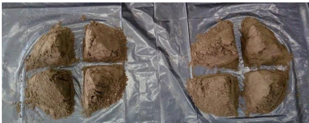
Figura 4-2: Pilhas cônicas utilizadas para homogeneização e quarteamento da amostra de escória.
