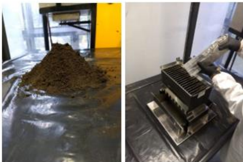
Figura 4-3: Preparo de amostra para caracterização química, física e ensaio de extração. Homogeneização em pilha cônica e quarteamento em quarteador do tipo Jones.
