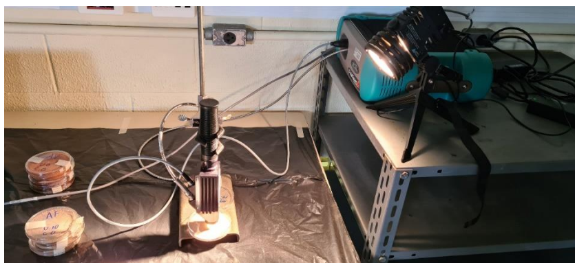
Figura 24 - Arranjo utilizado para as leituras dos espectros das amostras com o espectrorradiômetro ASD FieldSpec® 4 Hi-Res
