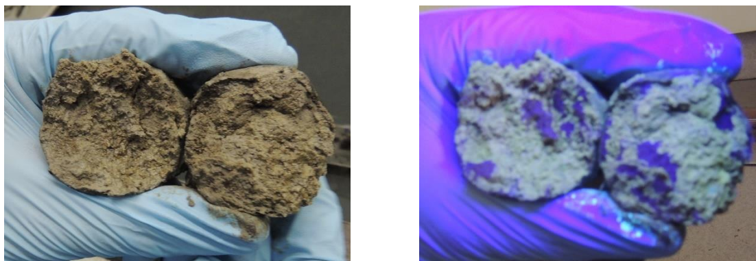
Figura 43 - Amostra de campo coletada na unidade 01 (AV), irradiada com luz UV-A evidenciando a distribuição anisotrópica da contaminação residual na zona vadosa por meio da fluorescência dos HPAs
