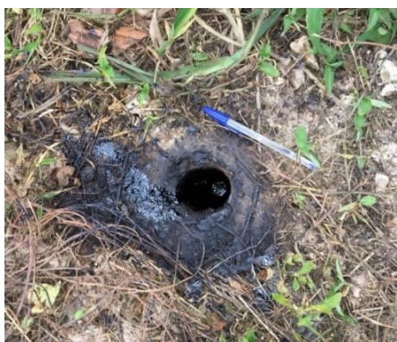
Figura 19 - Perfuração e amostra de óleo creosoto coletados sob as antigas estruturas das autoclaves da UTM Jaguaré
