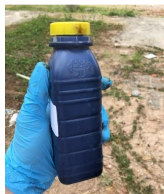
Figura 19 - Perfuração e amostra de óleo creosoto coletados sob as antigas estruturas das autoclaves da UTM Jaguaré
