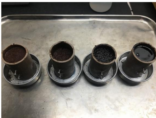
Figura 22 - Preparo das amostras AV para as concentrações de 5 %, 10 %, 20 % e 30 %, sendo possível visualizar o aumento das concentrações de creosoto nas amostras
