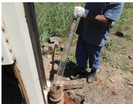
Figura 16 - Inserção do amostrador EGEO na haste de cravação
