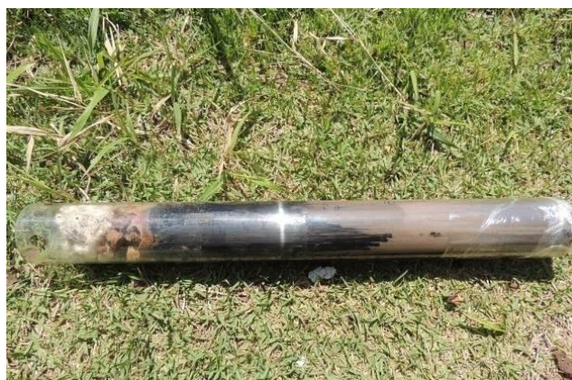
Figura 17 - Amostrador após coleta, demonstrando a variação estratigráfica
