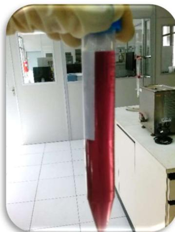
Figura 49. Dosagem de excesso de  $O_3$  com formação do íon  $MnO_4^-$  no pH 0,5.
