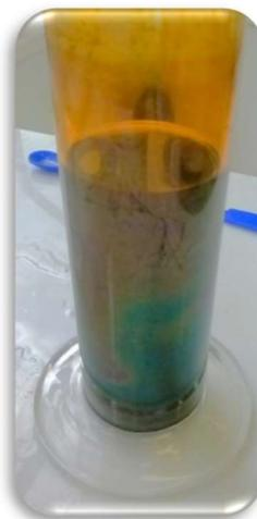
Figura 43. Precipitação coloidal no reator.
