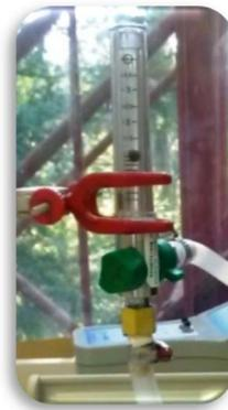
Figura 20. Fluxômetro para medição de vazão de  $O_2$ .
