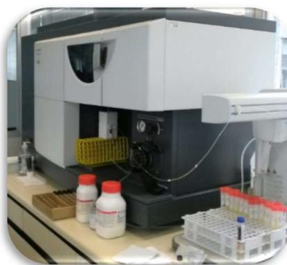
Figura 23. Espectrômetro de emissão óptica – ICP-OES.
