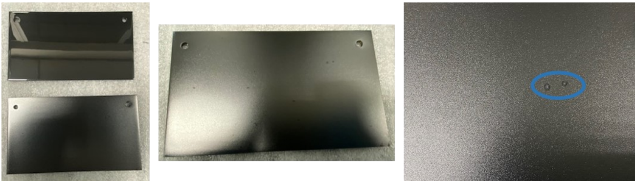
Figura 30 - Ensaio de salt spray após 24 h em amostra revestida com TiCN e Bias de 50 V
