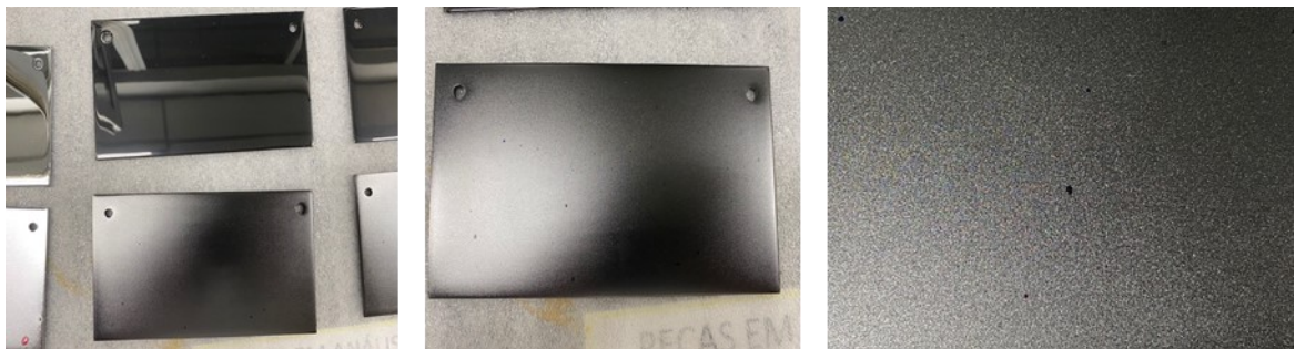
Figura 32 - Ensaio de salt spray após 72 h em amostra revestida com TiCN e Bias de 150 V
