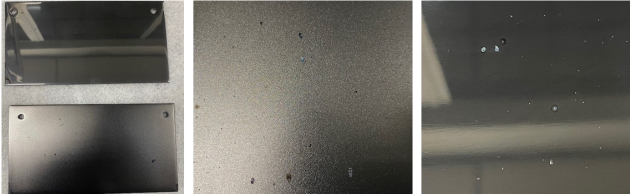
Figura 31 - Ensaio de salt spray após 24 h em amostra revestida com (TiCr)CN
