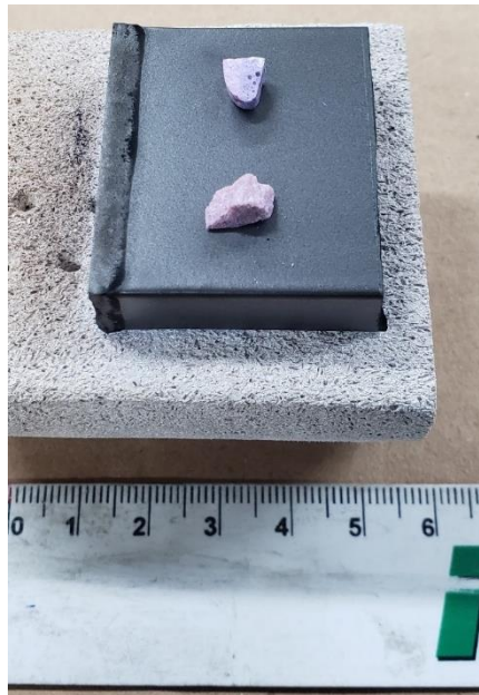
Figura 68 – Amostras de sais sobre substrato de carbono
