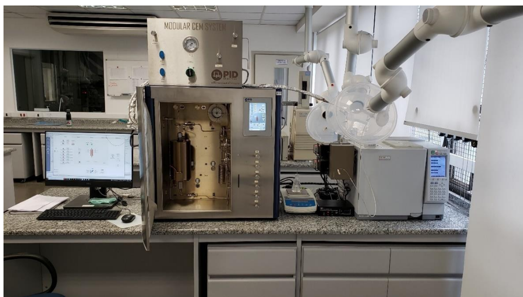
Figura 9: Sistema utilizado para os testes catalíticos.
