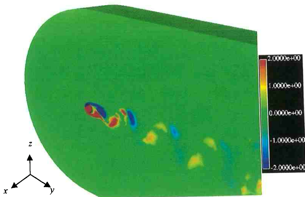
Fig. 5.31. Componente da vorticidade w_x na direção do eixo do cilindro para Re=250 e comprimento do cilindro igual a 5D .
