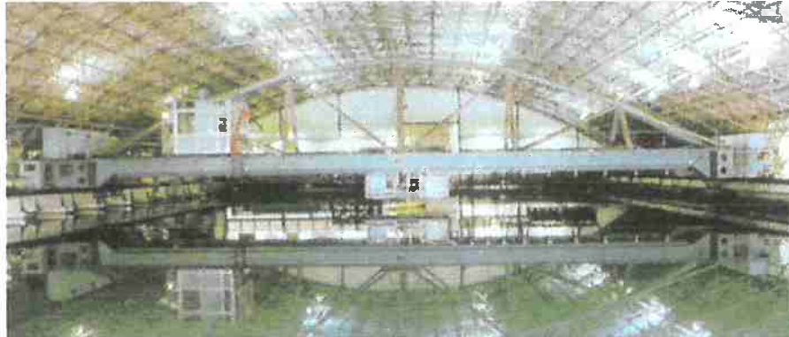
Fig.2.4 – Tanque de provas oceânico de manobras
