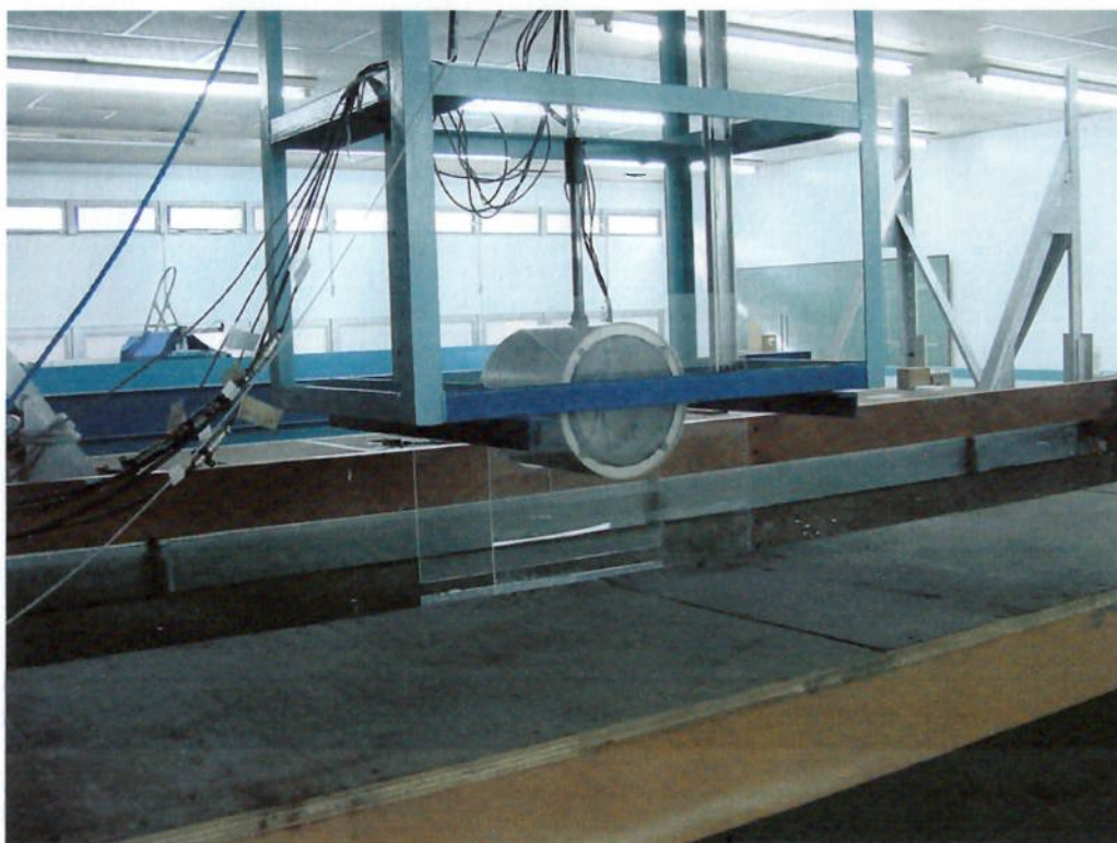
Figura A2.5: Modelo de cilindro na ocasião do teste com placas solidárias.
