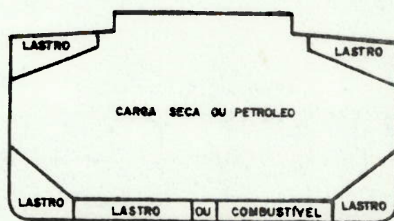
Secção mestra típica de um navio graneleiro combinado (OBO)
