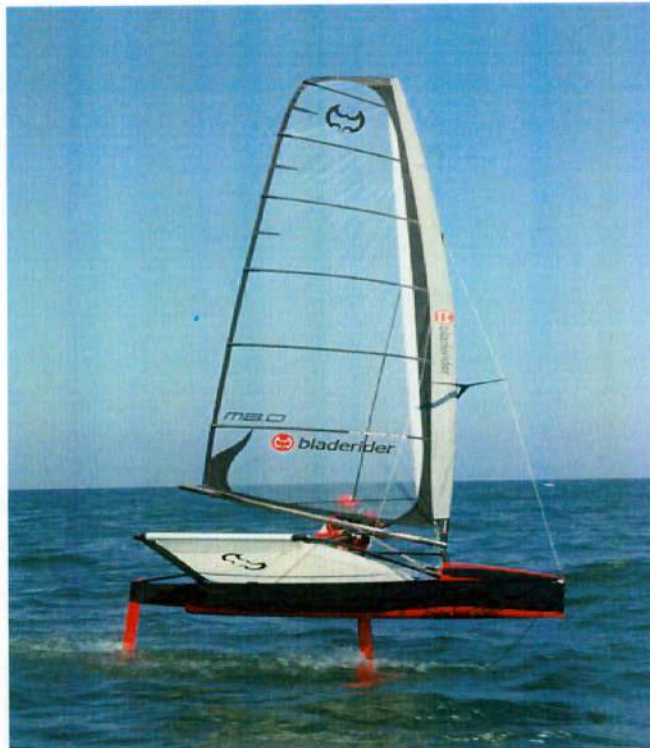
Figura 1.10: Moth na configuração dos irmãos Ilett
