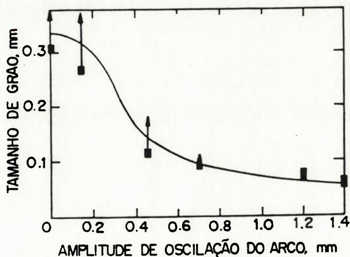
Fig.4.5 - Efeito da amplitude da oscilação do arco no tamanho de grãos da zona fundida da liga Al-2.5Mg [59]
