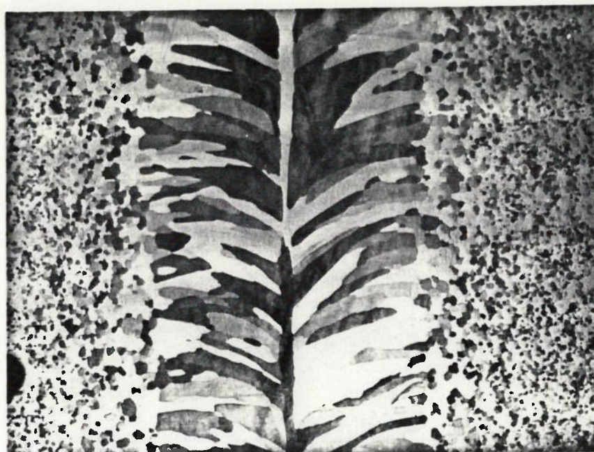
Fig.6.9 - Micrografia do cordão de solda obtido na condição como soldado. Polimento mecânico. Ataque com a solução A. Condições de soldagem: I = 80A , E = 14V e V = 3.25mm/s , sem oscilação. Aumento: 3.2; ampliação: 4.4 vezes.
