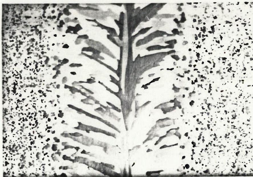
Fig.6.2 - Micrografia do cordão de solda obtido na condição como soldado. Polimento mecânico. Ataque com a solução A. Condições de soldagem: I = 80A , E = 14V e V = 3.25mm/s , sem oscilação magnética do arco. Aumento: 3.2 vezes; ampliação: 4.4 vezes.
