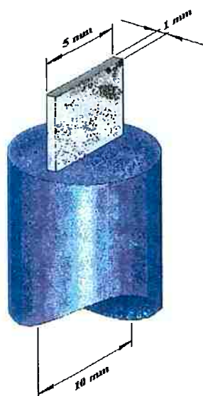
Figura 4.3: Detalhe da Seção Transversal Interna do Modelo Flexível. Note a Assimetria Estrutural aliada à Simetria Geométrica.
