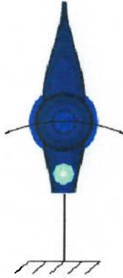
Fig. A24 - Representação esquemática do ensaio para obtenção do momento de inércia do modelo do VSNT Jati I.
