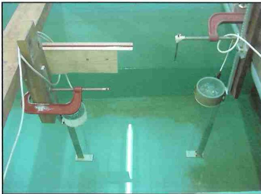
Figura 3.10 - Ilustração do arranjo para aferição dinâmica do ondômetro (direita) e o ondômetro testemunha (esquerda).
