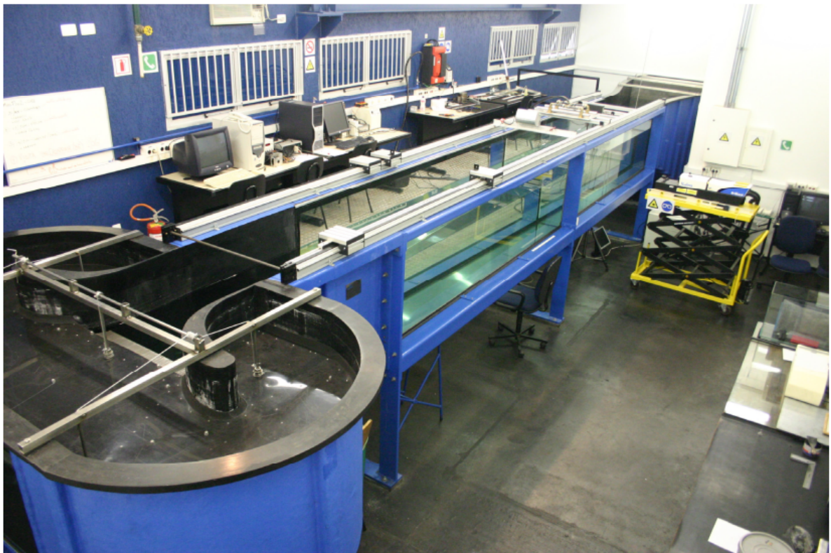
Figura 22 – Canal de água recirculante do NDF ( ASSI, 2005 )
