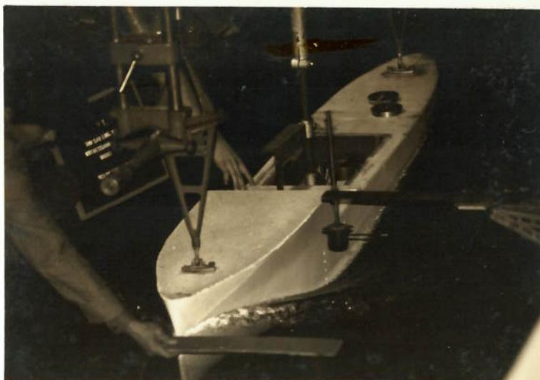
Figura 5 - Ensaio de um mono-casco ( $V_n/\sqrt{gL} = 0,30$ ) gerado pela série de Taylor de características:
