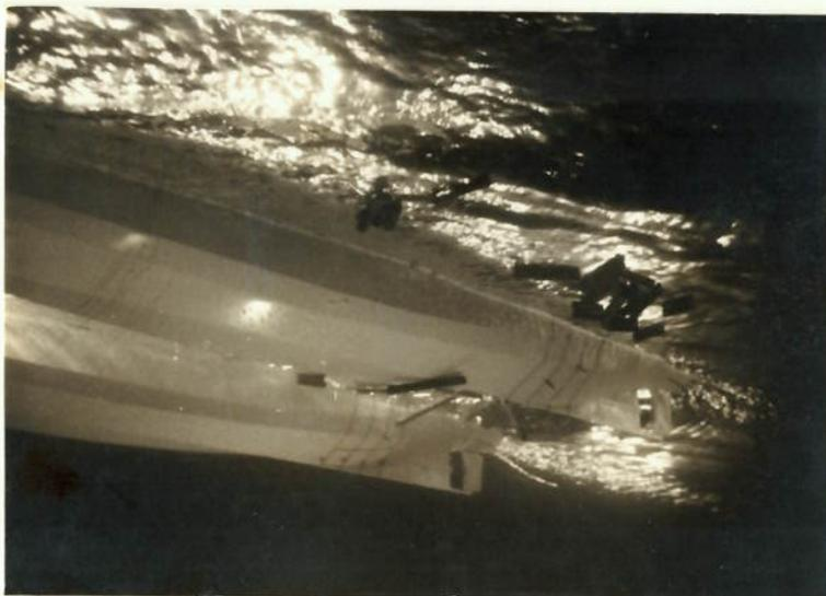
Figura 30 - Ensaio de troncos - Vista subaquática da região de popa do modelo do catamarã -  $V = 11$  nós
