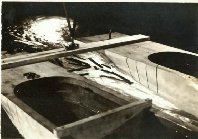
Figura 28 - Ensaio de troncos - Vista superior da região de ré do modelo do catamarã -  $V = 11$  nós
