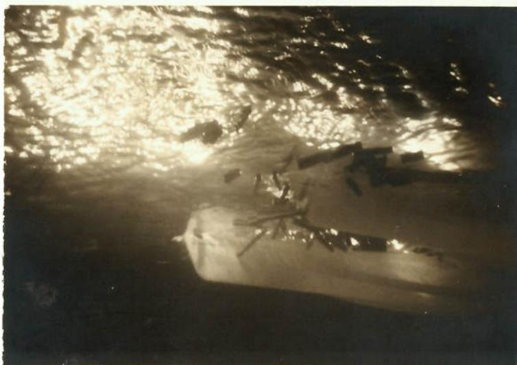
Figura 29 - Ensaio de troncos - Vista subaquática da região de proa do modelo do catamarã -  $V = 11$  nós
